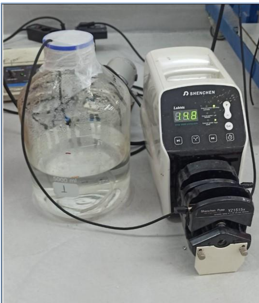
Σχήμα 4:7 Τροφοδοσία οξειδωτικού μέσου PS με περισταλτική αντλία.
