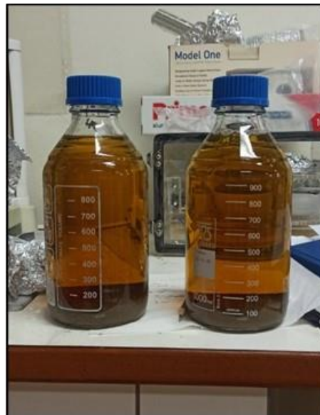
Σχήμα 4:5 Κατιονική ρητίνη R-Fe μέσα σε εκχύλιμα πράσινου τσαγιού ώστε να παραχθεί R-nFe.
