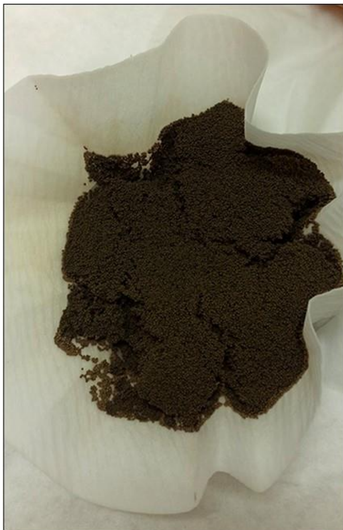
Σχήμα 4:2 Η κατιονική ρητίνη R-nFe με τον ενσωματωμένο νανοσίδηρο.
