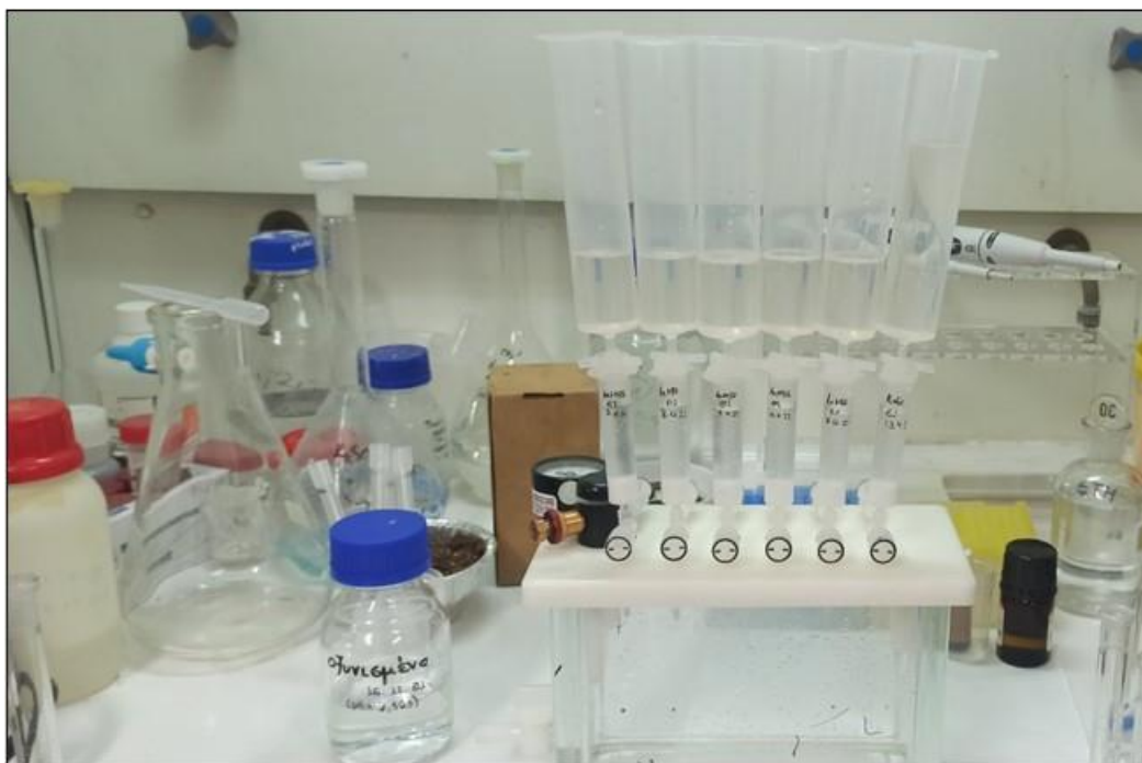
Σχήμα 4:8 Φωτογραφική απεικόνιση της συσκευής κενού (Agilent Technologies), των πλαστικών συρίγγων και των φυσιγγών C18 που χρησιμοποιούνται κατά την εκχύλιση στερεής φάσης.
