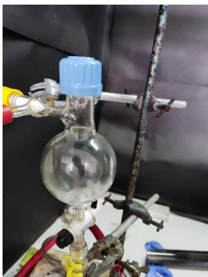
Σχήμα 53. Ανάμιξη ρευμάτων αερίων
