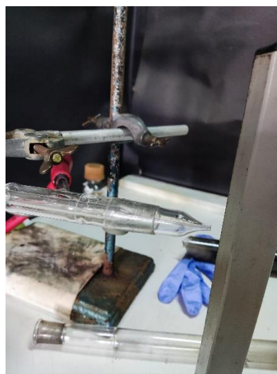
Σχήμα 54. Ακροφύσιο εισόδου αερίων στον αντιδραστήρα
