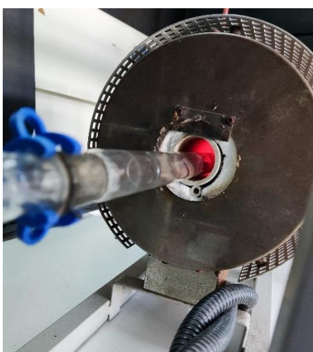
Σχήμα 62. Αντιδραστήρας CVD σε λειτουργία
