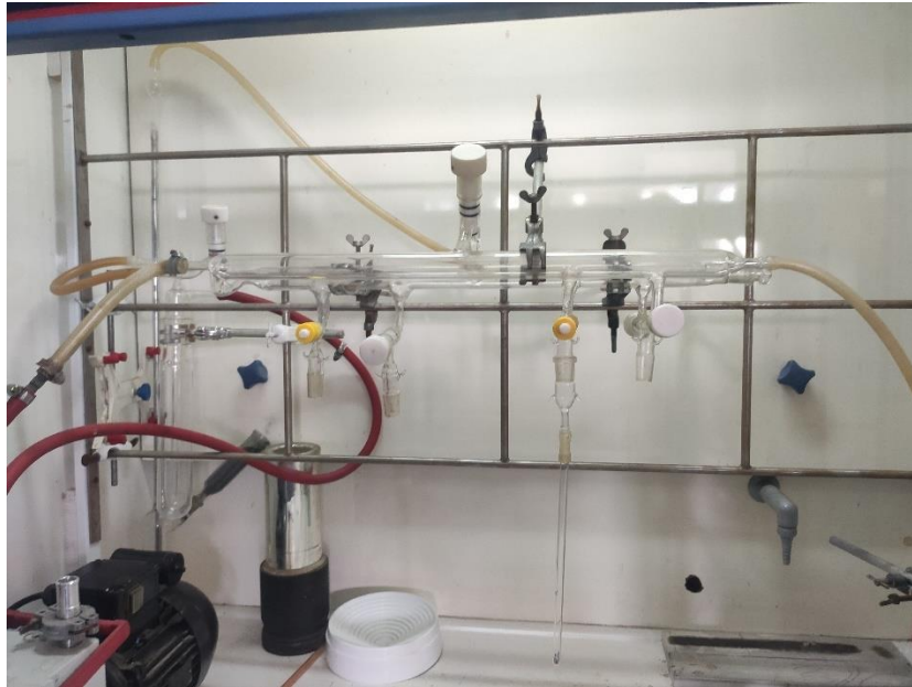
Σχήμα 38. Διάταξη στεγανοποίησης υπό κενό.
