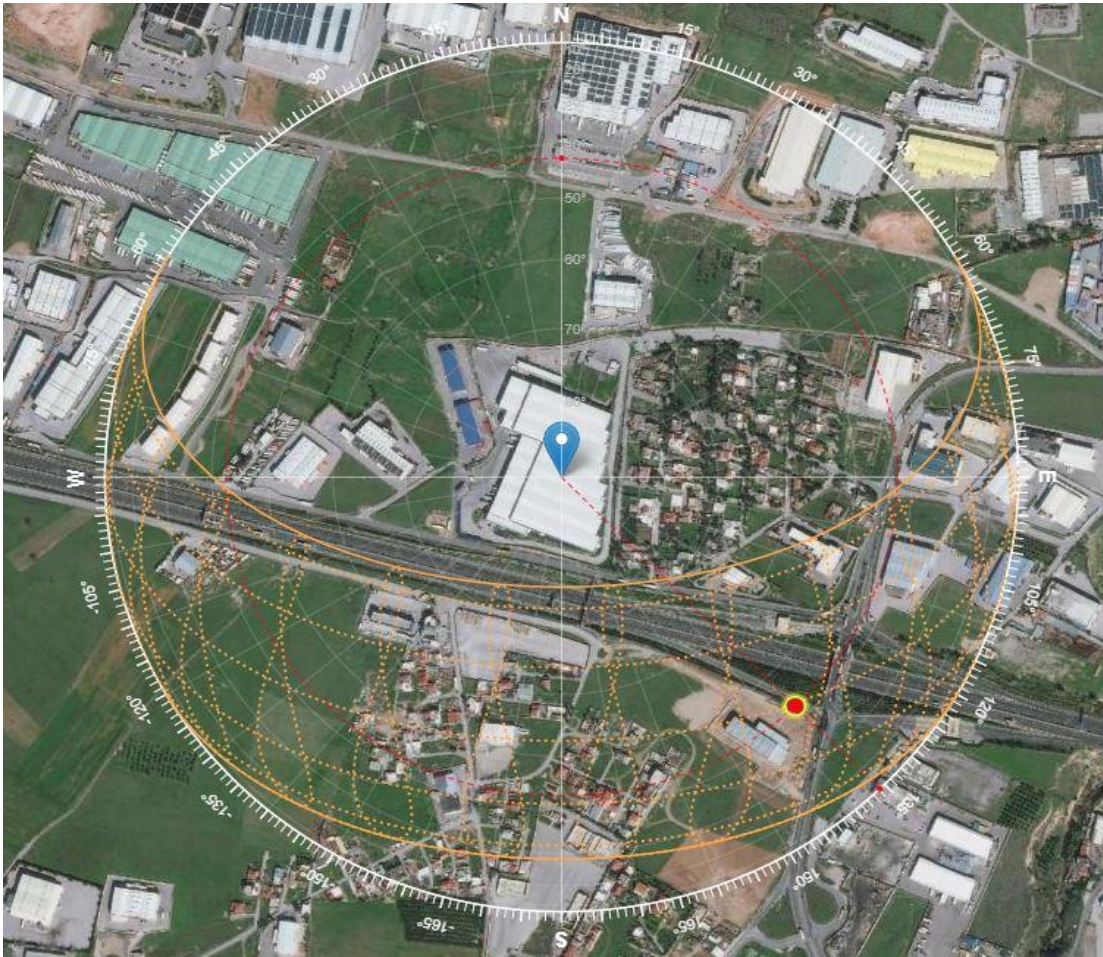
Εικόνα 25: Ηλιακό Διάγραμμα της Εγκατάστασης [10]
