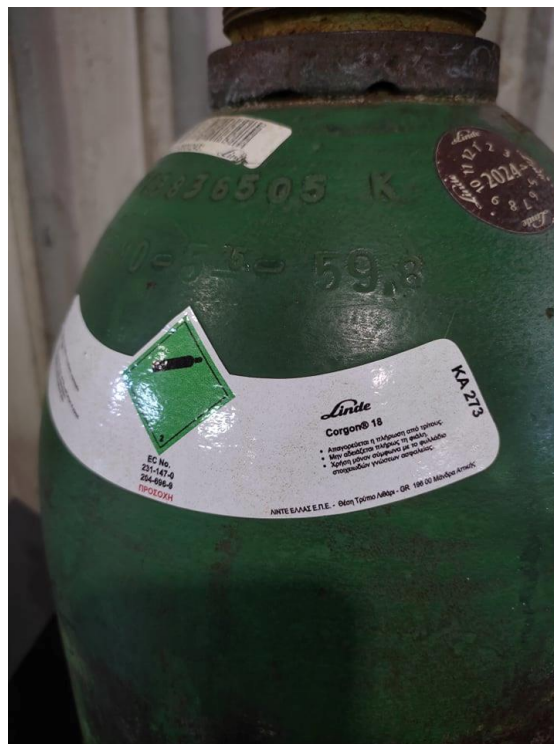
Εικόνα 3.6. Φιάλη υψηλής πίεσης προστατευτικού αερίου “CORPON 18”
