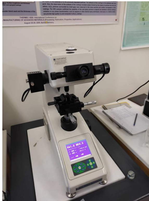
Εικόνα 3.11. Μικροσκληρόμετρο “Wolpert – Wilson 402 MVD” του Ε.Ν.Τ.
