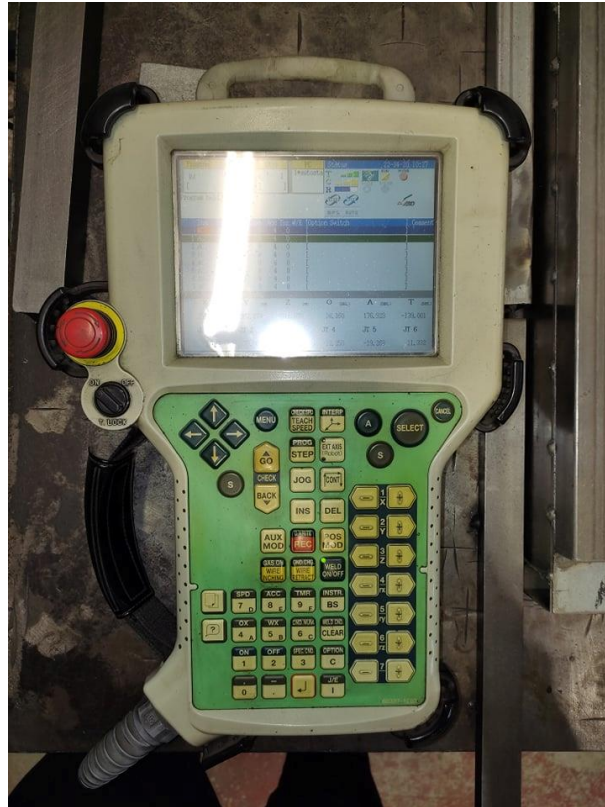
Εικόνα 3.5. Χειριστήριο εκμάθησης-προγραμματισμού ή “teach pendant” ρομποτικού βραχίονα “KAWASAKI”
