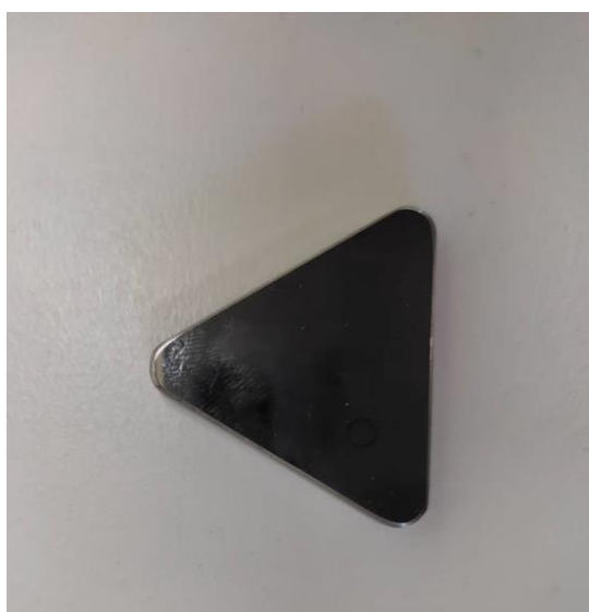
Εικόνα 3.13. Πρότυπο πλακίδιο της εταιρίας “MPA NRW” για τον έλεγχο της αξιοπιστίας των μικροσκληρομετρήσεων
