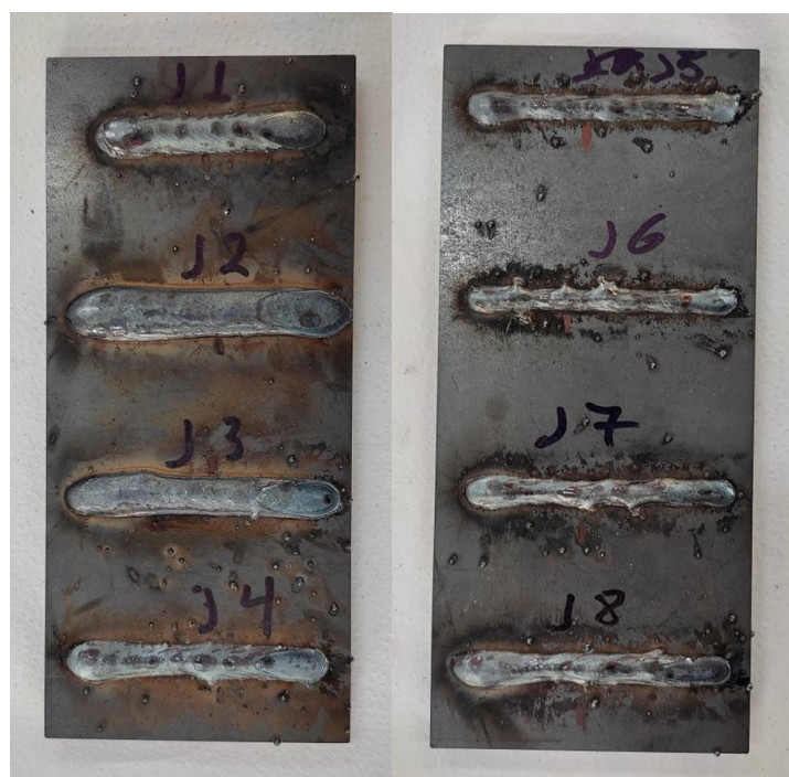
Εικόνα 4.1. Ραφές εναποθέσεων BoP δοκιμίων J1-J8 (κάτοψη)
