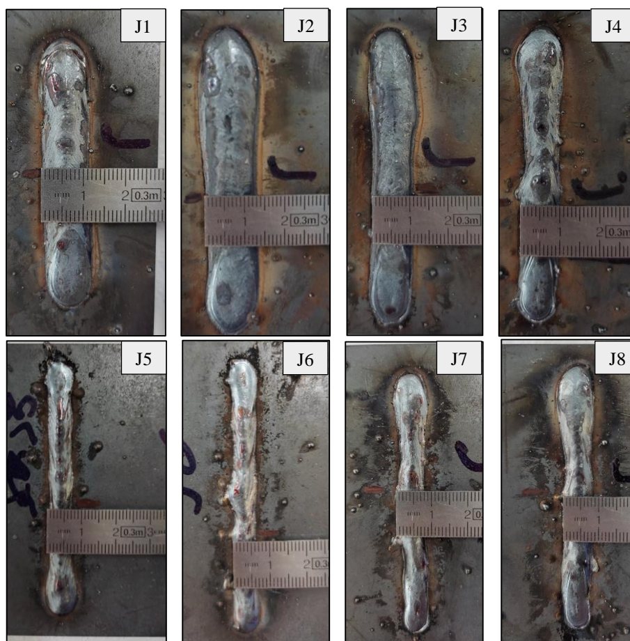
Εικόνα 4.2. Ραφές εναποθέσεων BoP δοκιμίων J1-J8 (κάτοψη με κλίμακα κατά το πλάτος)
