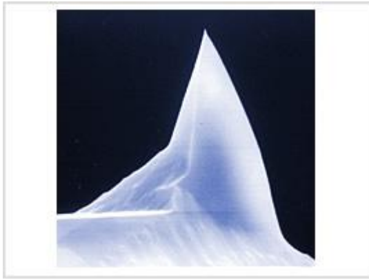
Σχήμα 6.5 : Γεωμετρία ακίδας για λειτουργία σε conductive-AFM
