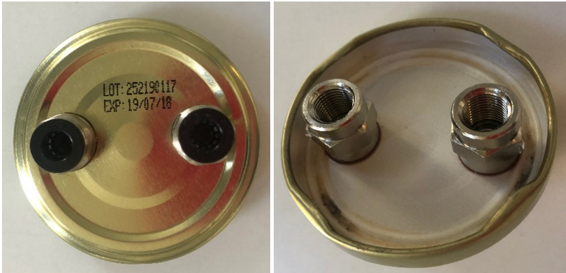
Εικόνα 4.12 Πώμα με αυτόματα ρακόρ αέρα (αριστερά) στερεωμένα με μούφες 6 mm (δεξιά)
