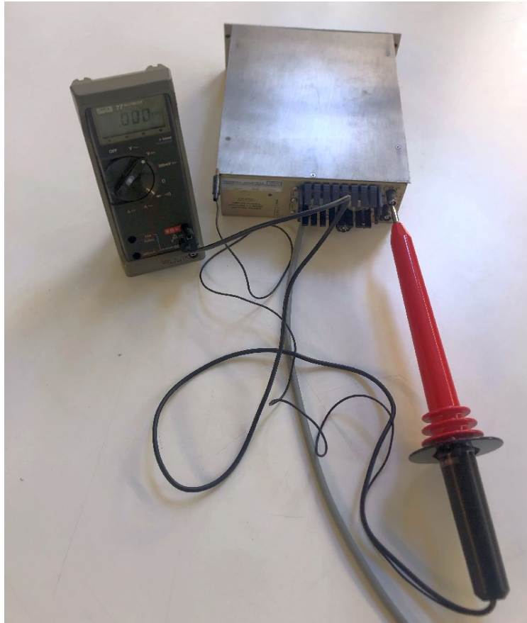
Εικόνα 3.12: Έλεγχος παραγόμενης υψηλής τάσης από το τροφοδοτικό CANBERRA τύπου 3002. Χρησιμοποιείται High Impedance Probe και απλό πολύμετρο.
