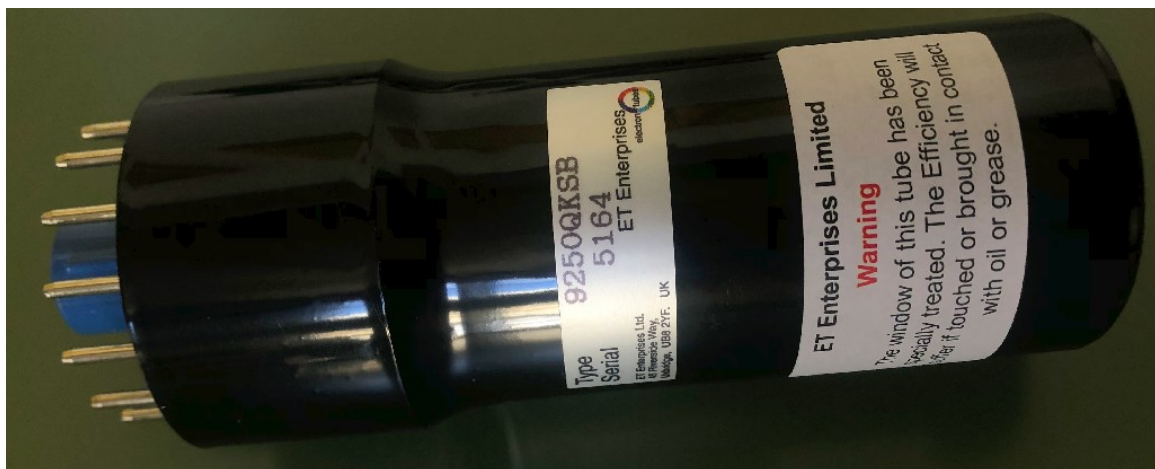
Εικόνα 3.2: Φωτοπολλαπλασιαστής ονομαστικής διαμέτρου 2", εταιρείας κατασκευής ET Enterprises, τύπου 9250QKSB, 10 σταδίων, 14 επαφών
