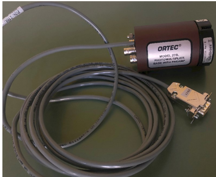
Εικόνα 3.1: Προενισχυτής τύπου ORTEC 276L με ενσωματωμένο διαιρέτη τάσεως 10 σταδίων (διαιρέτης: photomultiplier base)
