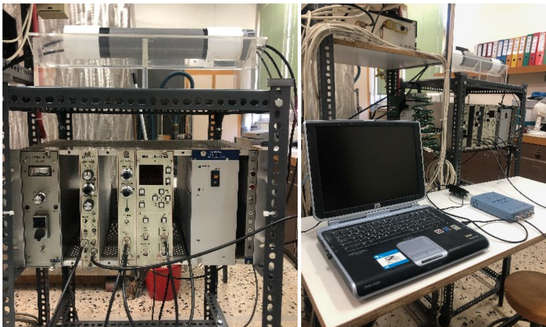
Εικόνα 6.1: Συγκροτημένη διάταξη μετρήσεων. Πάνω, στο ντέξιον: NIM BIN με (από αριστερά) τροφοδικό υψηλής τάσης, ενισχυτής, διαχωριστής, καταμετρητής, τροφοδικό NIM. Κάτω στο τραπέζι (από δεξιά) εξωτερική μονάδα παλμογράφου, απομόνωση θορύβου USB (μαύρο κουτί στο μέσον), φορητός ΗΥ για τον παλμογράφο.
