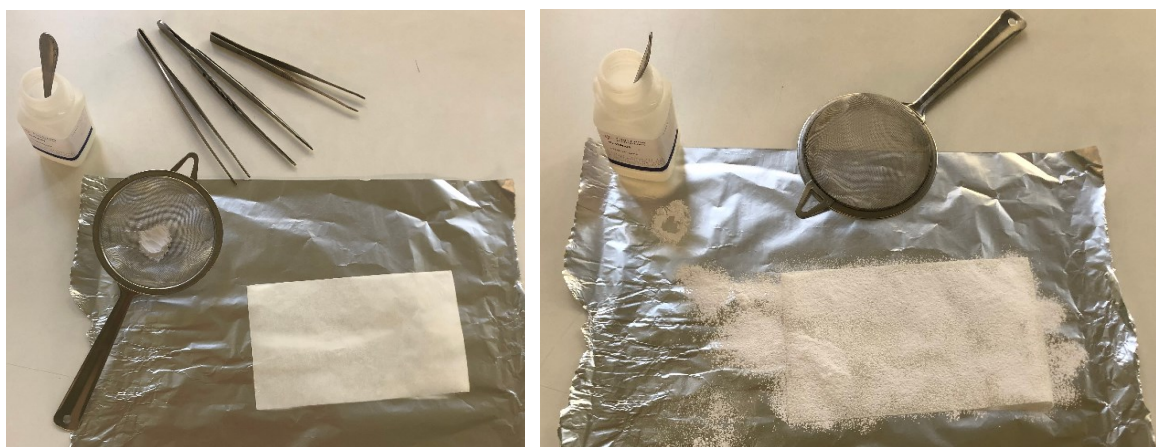
Εικόνα 4.9: Διαδικασία για το διασκορπισμό σκόνης σπινθηριστή σε φύλλο λαδόκολλας.
