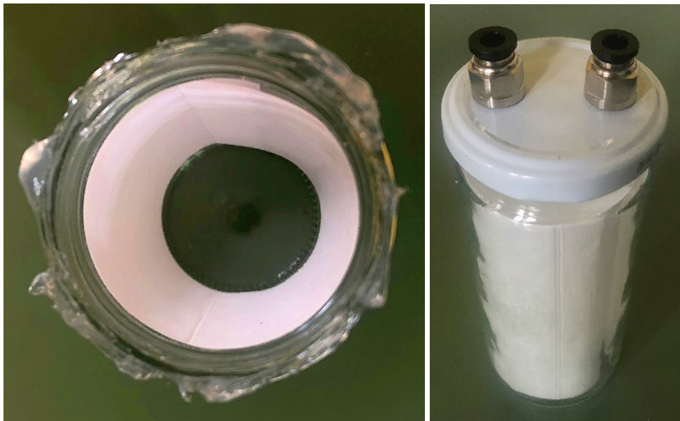
Εικόνα 4.13: Αριστερά: γυάλινο δοχείο με σιλικόνη στο χείλος. Δεξιά: Σφραγισμένο δοχείο LC
