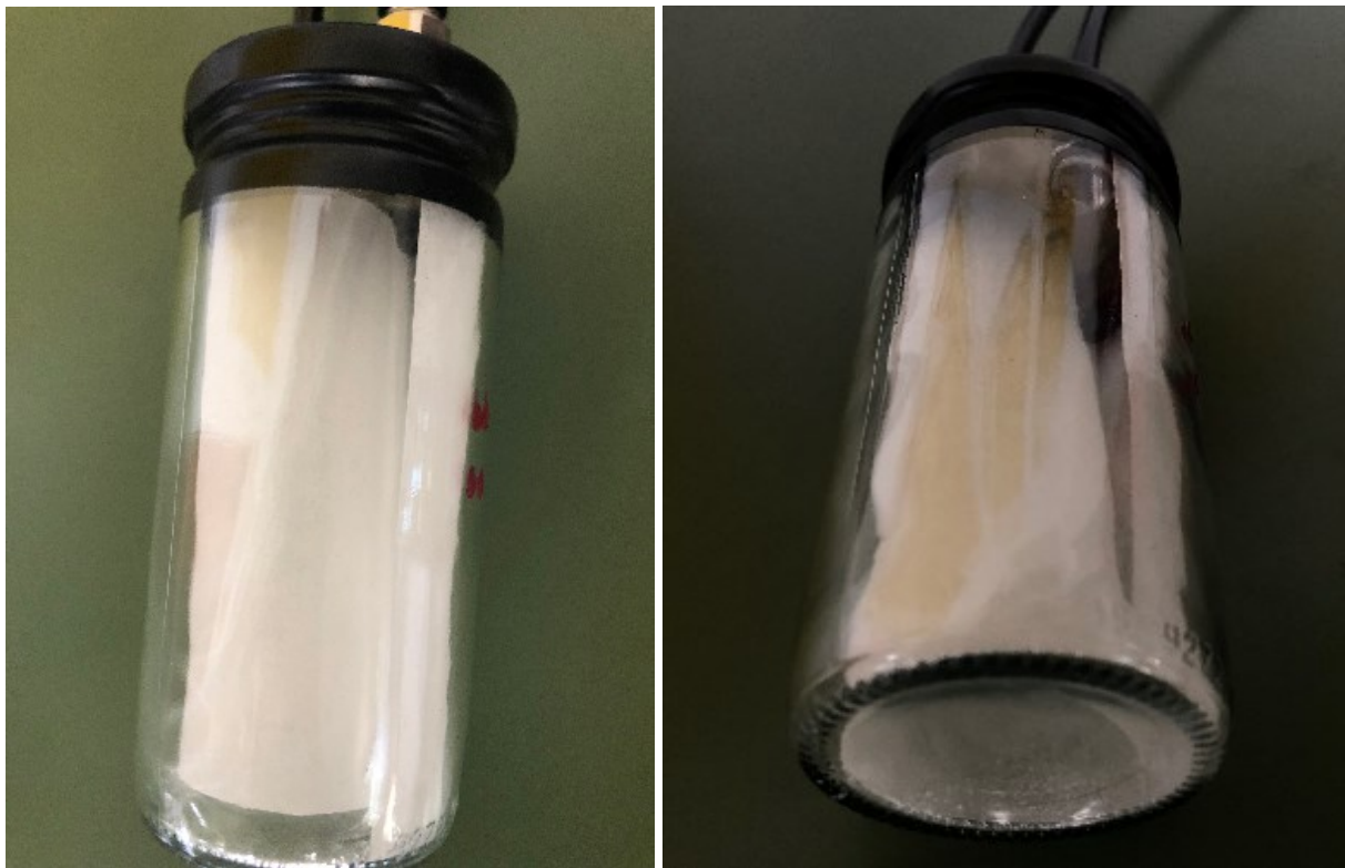
Εικόνα 6.5: Απώλεια γεωμετρίας ανιχνευτικού αντικολλητικού φύλλου με σπινθηριστή ZnS(Ag) , η πιθανότερη αιτία είναι η υγρασία του αέρα.
