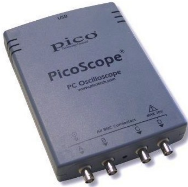
Εικόνα 3.16: Ψηφιακός παλμογράφος PICOSCOPE 3424, τεσσάρων εισόδων A, B,C και D, συνδεσιμότητας USB
