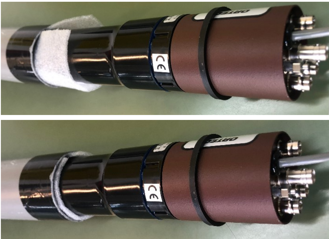
Εικόνα 4.20: Τοποθέτηση του συστήματος φωτοπολλαπλασιαστή - διαιρέτη τάσης - προενισχυτή στον σωλήνα PVC
