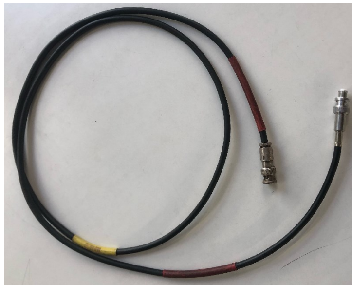
Εικόνα 3.15: Ειδικό καλώδιο υψηλής τάσης "ΑΡΣ BNC βρετανικού τύπου ↔ ΘΗΛ BNC αμερικάνικου τύπου". Κέντρο - Αριστερά: Βύσμα ΑΡΣ BNC βρετανικού τύπου. Δεξιά: Βύσμα ΘΗΛ BNC αμερικάνικου τύπου
