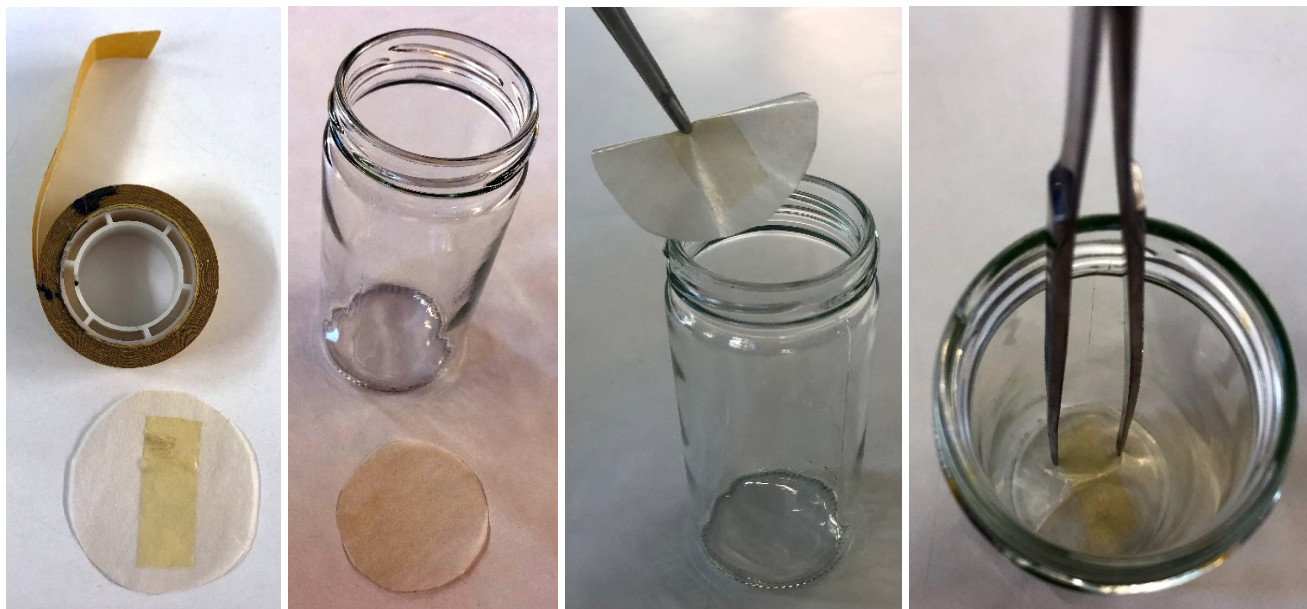
Εικόνα 4.3: Κάλυψη της βάσης του δοχείου με χαρτί ώστε να μην καλυφθεί με κόλλα και σπινθηριστή και να παραμείνει διαφανές για την εύκολη μετάδοση του φωτός προς τον φωτοπολλαπλασιαστή. Αριστερά διακρίνεται και η ταινία διπλής όψης για τη στερέωση του χαρτιού.
