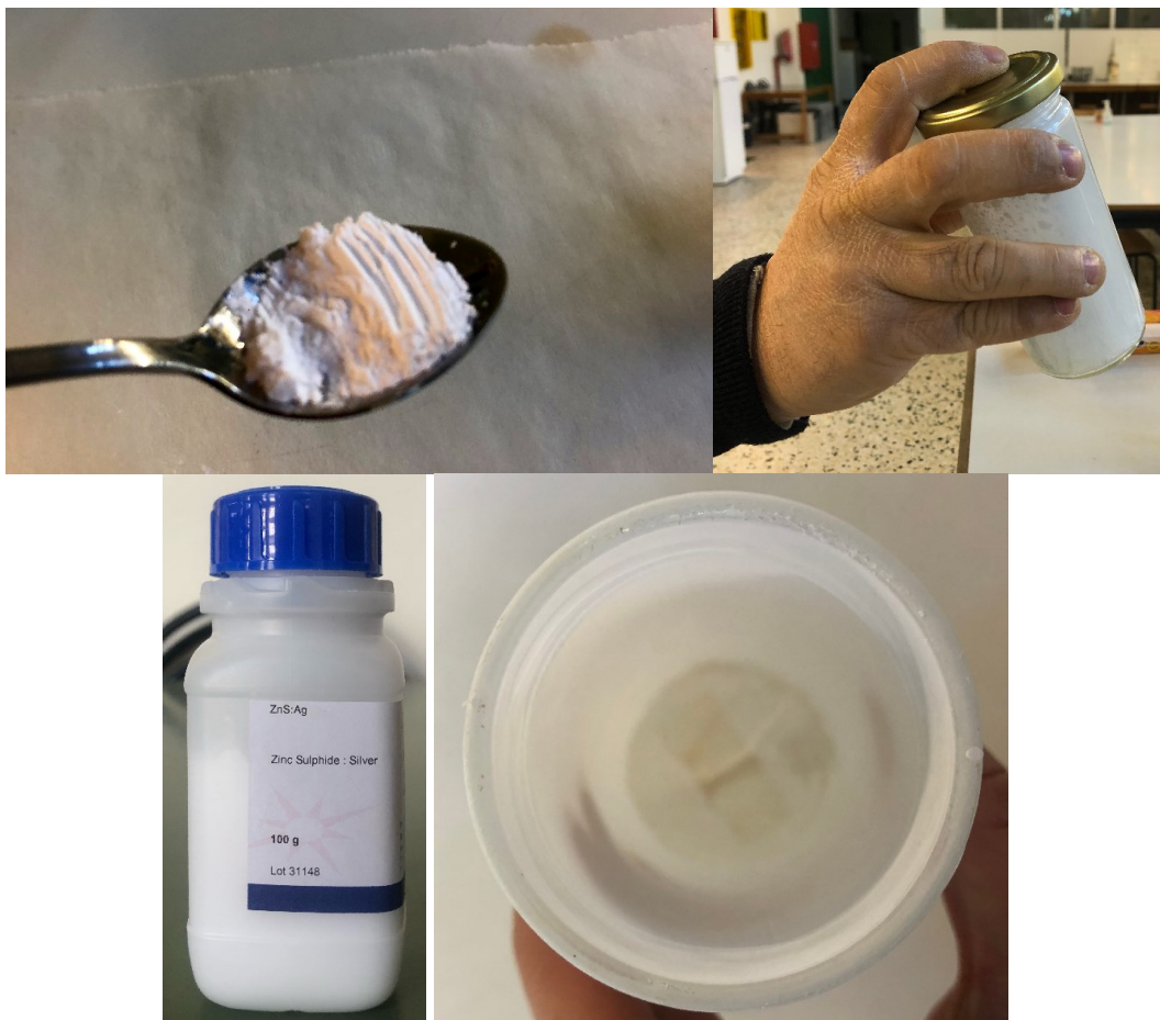
Εικόνα 4.5: Επικόλληση σπινθηριστή στα εσωτερικά τοιχώματα του δοχείου. Πάνω αριστερά: ~2.5 mL σπινθηριστή. Πάνω δεξιά: ανακίνηση δοχείου. Κάτω αριστερά: Δοχείο συσκευασίας με σπινθηριστή, Κάτω δεξιά: τελικό αποτέλεσμα λεπτού στρώματος ομοιόμορφα κατανεμημένου σπινθηριστή.
