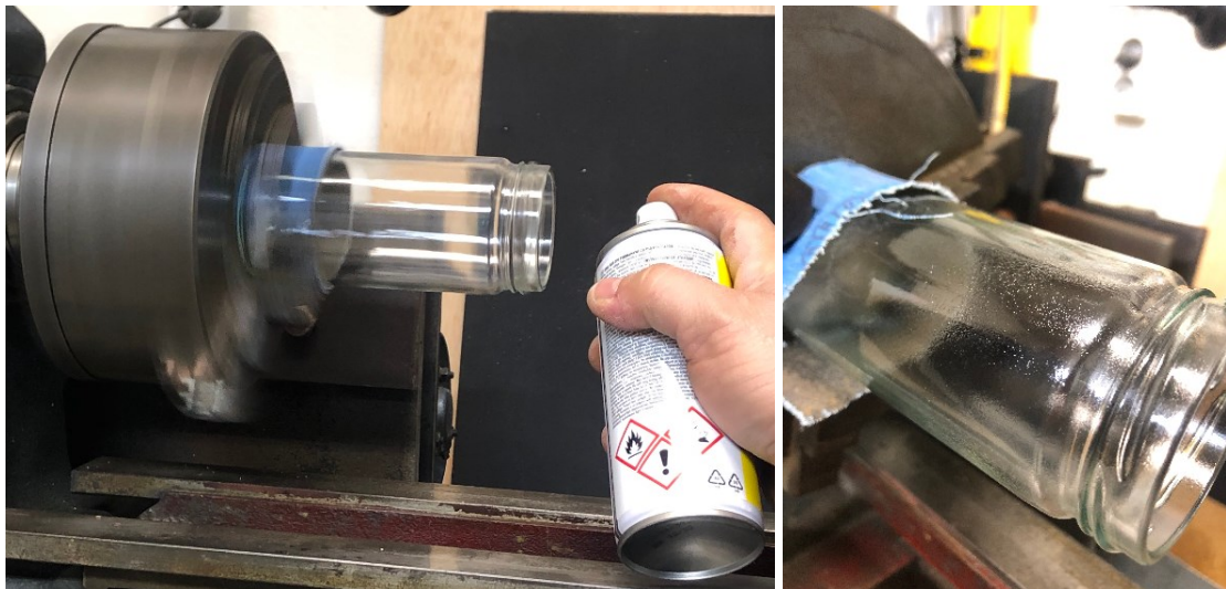
Εικόνα 4.4: Ψεκάσμος των εσωτερικών τοιχωμάτων του δοχείου με κόλλα σε σπρέι. Πάνω: στερέωση στον τόρνο, Κάτω αριστερά: περιστροφή και ψεκάσμος, Κάτω δεξιά: τελικό αποτέλεσμα λεπτού στρώματος κόλλας.
