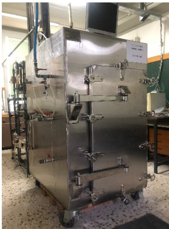
Εικόνα 5.3: Θάλαμος Ραδονίου "Α" στο ΕΠΤ-ΕΜΠ
