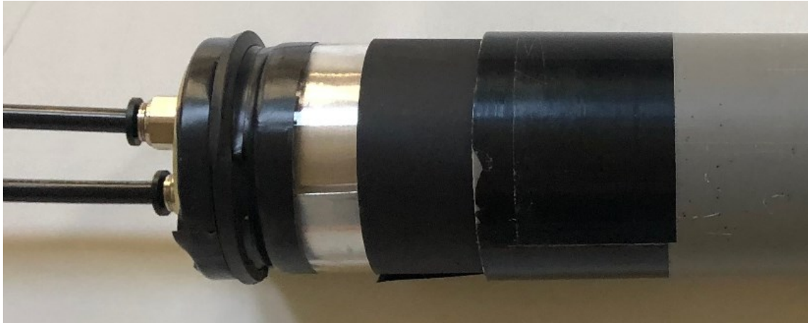
Εικόνα 4.18: Τοποθέτηση του δοχείου LC στο σωλήνα PVC
