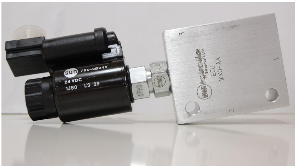
Εικόνα 4.23: Διάταξη ηλεκτροαναλογικών βαλβίδων για την επιβολή φορτίου.
