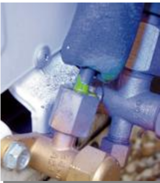
Εικόνα 3.1:Ειδική βαφή Oil-Glo (Advanced Engineering Ltd Basingstoke UK).
