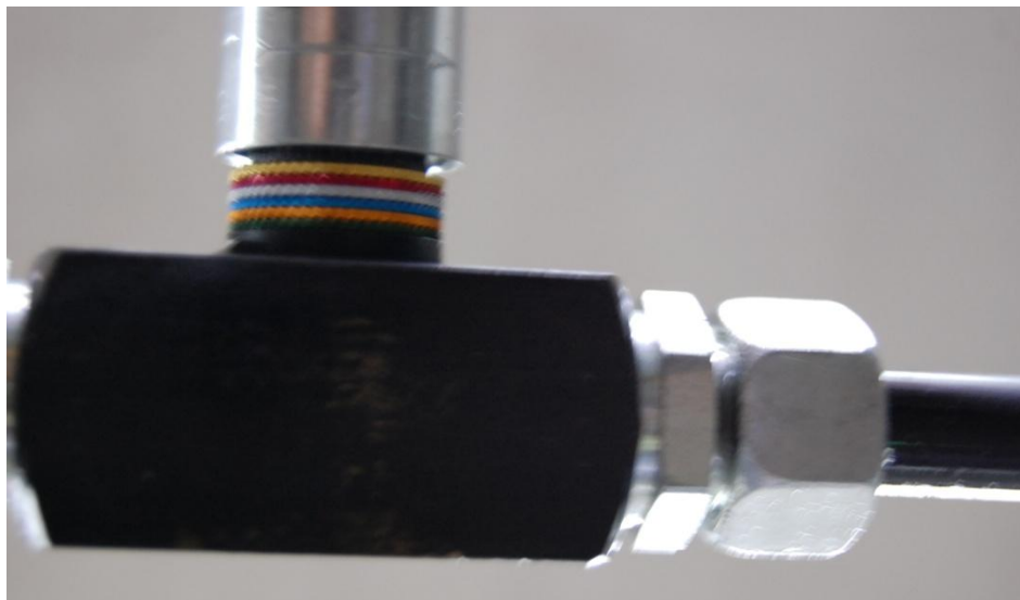
Εικόνα 4.20: Ρυθμιστικοί δακτύλιοι βελονοειδούς βαλβίδας 9N800S (Parker Hannifin Corporation).
