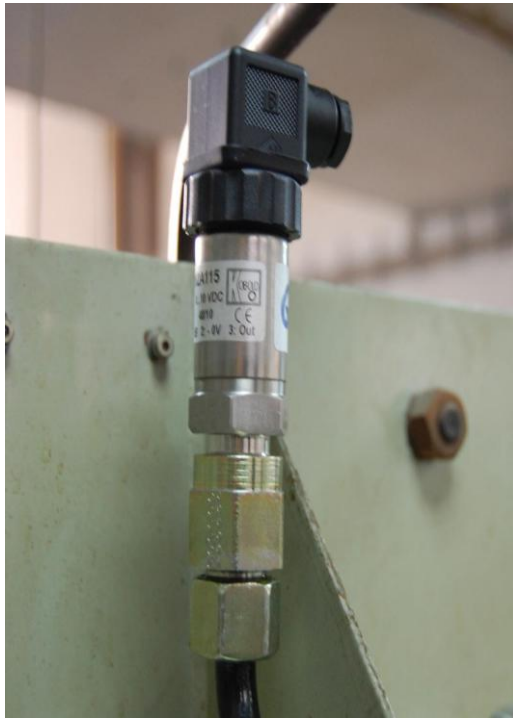
Εικόνα 4.8: Μεταλλάκτες πίεσης SEN-8601/2 A115 (KOBOLD Messring GmbH).
