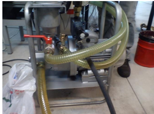
Εικόνα 5.3: Off-line κινητή εγκατάσταση καθαρισμού υδραυλικού ρευστού.
