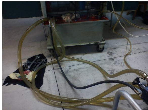
Εικόνα 5.4: Σύνδεση off-line κινητής εγκατάστασης καθαρισμού με το υδραυλικό κύκλωμα Herion.
