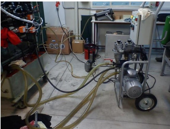
Εικόνα 5.4: Σύνδεση off-line κινητής εγκατάστασης καθαρισμού με το υδραυλικό κύκλωμα Herion.
