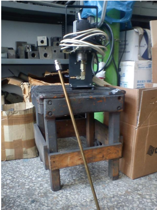
Εικόνα 5.2: Αντλία κυκλοφορίας της εταιρείας HYDAC και κύκλωμα δειγματοληψίας.
