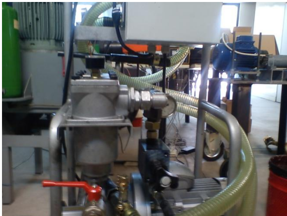
Εικόνα 5.3: Off-line κινητή εγκατάσταση καθαρισμού υδραυλικού ρευστού.
