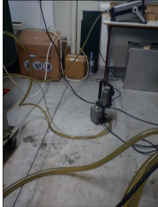
Εικόνα 5.2: Αντλία κυκλοφορίας της εταιρείας HYDAC και κύκλωμα δειγματοληψίας.
