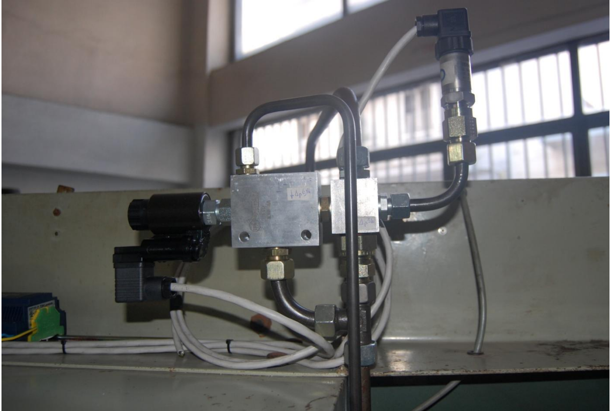
Εικόνα 4.24: Διάταξη για την επιβολή φορτίου.
