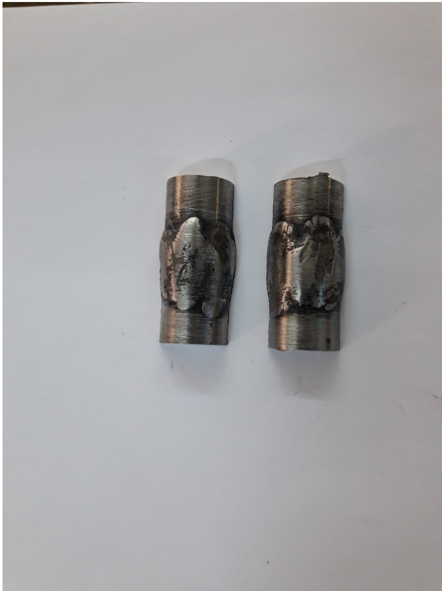
Εικόνα 19: Συγκολλημένα δοκίμια προς εξέταση. Τα δοκίμια κόπηκαν στον δισκοτόμο, κάθετα στην συγκόλληση.
