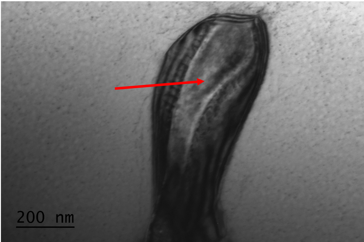
Εικόνα 38: Ηλεκτρονική Μικρογραφία Διερχόμενης δέσμης ηλεκτρονίων δοκιμίου 14. Παρατηρείται η κατακρήμνιση καρβιδίου τύπου MC, εμπλουτισμένο σε Ti (38.36% wt) και Mo (49.39% wt). Όπως φαίνεται και στην εικόνα β, ή οποία αποτελεί συνέχεια της α, το καρβίδιο έχει μορφολογία (script-like).
