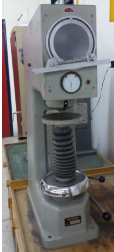
Εικόνα 22: Σκληρόμετρο Carl-Frank GmbH, στο οποίο πραγματοποιήθηκαν οι σκληρομετρήσεις κατά Vickers
