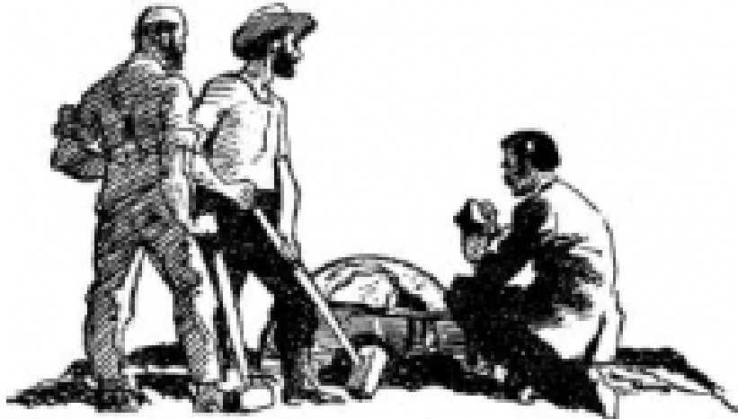
Εικόνα 3: Αναπαράσταση από την διαδικασία διαχωρισμού των σουλφιδίων χαλκού από τα σουλφίδια νικελίου, μέσω σφυρηλάτησης, κατά την μέθοδο tops and bottoms.
