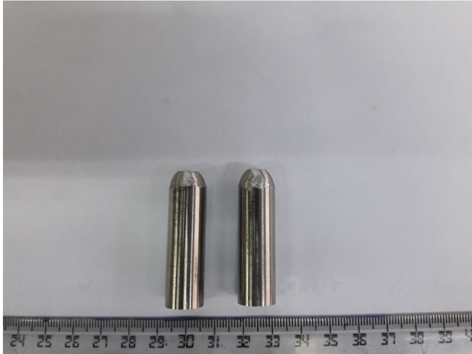
Εικόνα 17: Δοκίμια προς συγκόλληση, Haynes 282, έπειτα από κατάλληλη διαμόρφωση λοξοτομής.
