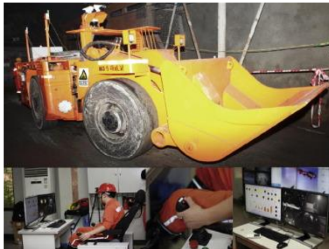
Εικόνα 26: Ένα έξυπνο υπόγειο scraper και η πλατφόρμα τηλεχειρισμού του στην επιφάνεια
