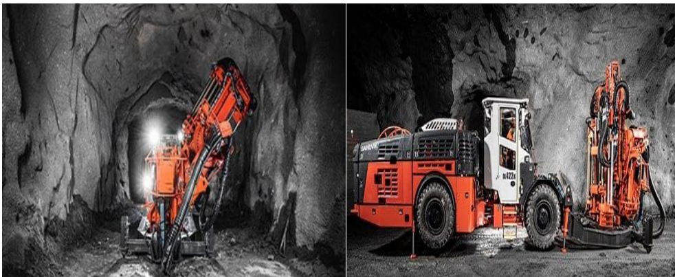
Εικόνα 6: Γεωτρήπανο Sandvik DL422iE
