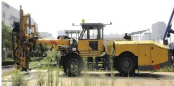
Εικόνα 23: Έξυπνο Jumbo γεωτρήσεων βράχου
