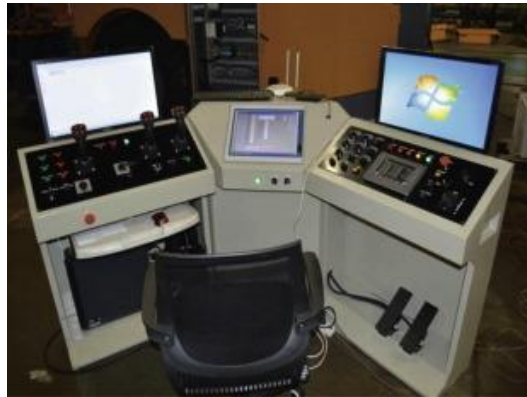
Εικόνα 22: Πλατφόρμα τηλεχειρισμού στην επιφάνεια με επιτόπια σήματα ήχου και εικόνας
