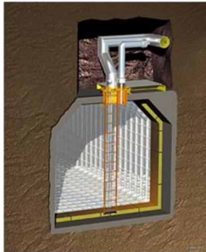
Εικόνα 3.7: Τομή του θαλάμου αποθήκευσης (Park et al., 2012)
