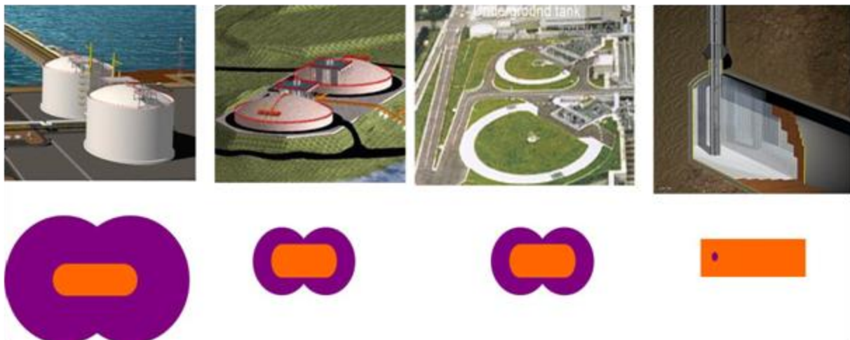
Εικόνα 2.1: Απαιτούμενη επιφάνεια για αποθηκευτικό χώρο 320,000m 3 (πορτοκαλί χρώμα: αποθηκευτικός χώρος, μωβ χρώμα: απαιτούμενος επιφανειακός χώρος) (Park et al., 2012)
