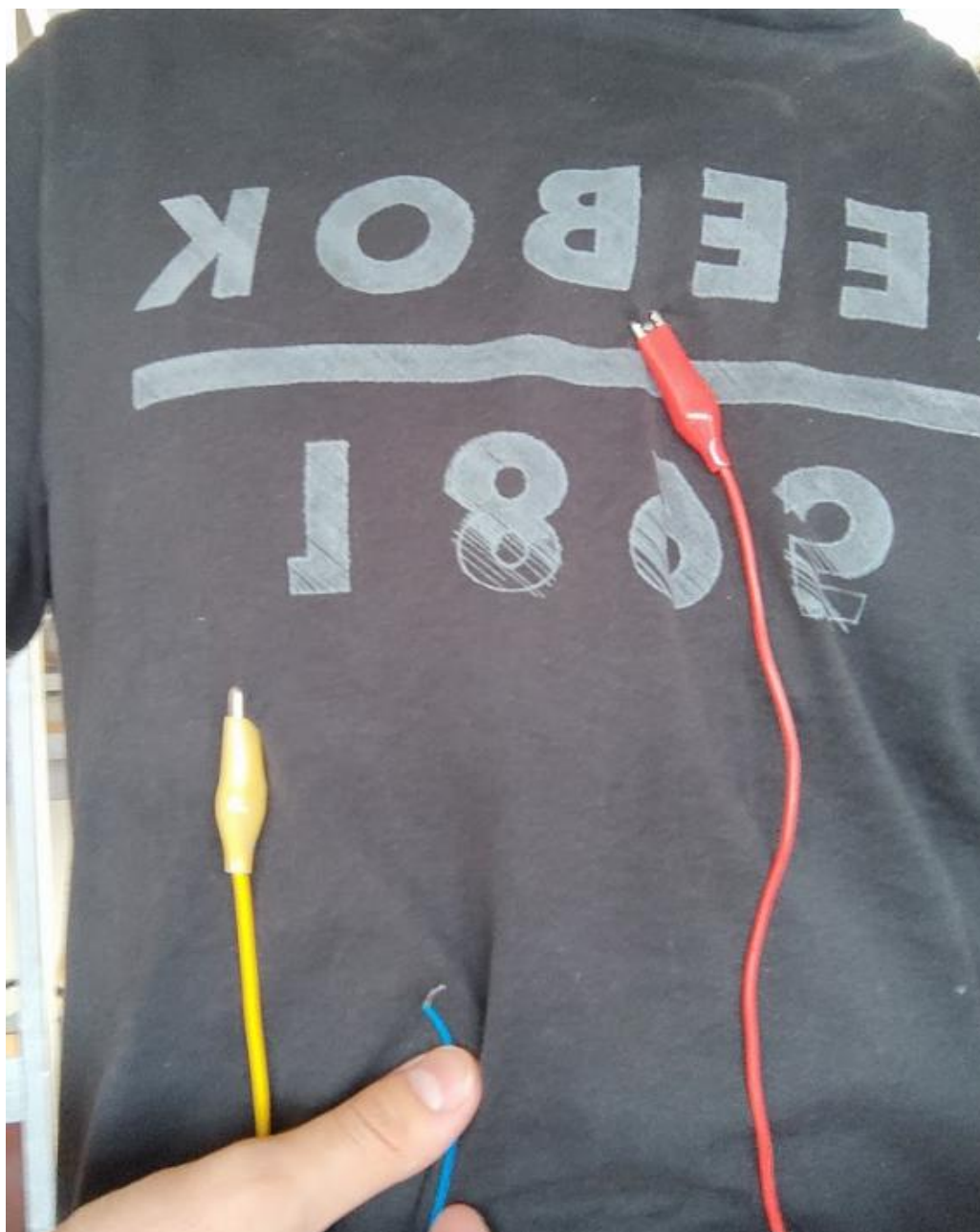
Σχήμα 40: Παρουσιάζεται η θέση των ηλεκτροδίων που τοποθετήθηκαν για την απόκτηση καρδιακού σήματος. Με κόκκινο καλώδιο συνδέθηκε το Vin+ του ενισχυτή , με το κίτρινο καλώδιο το Vin- του ενισχυτή, ενώ με μπλε καλώδιο γειώθηκε το σώμα στο gnd του κυκλώματος.
