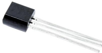
Σχήμα 13: Ο σταθεροποιητής τάσης σε 3.3 V LM2936.
