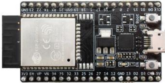
Σχήμα 20: Διαμόρφωση PIN του ESP32 DEVKITC V4.
