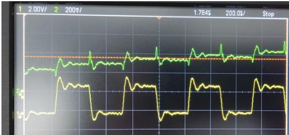
Σχήμα 28: MOSI και MISO pins λανθασμένη έξοδος, λόγω ασυμμετρίας στο GND.
