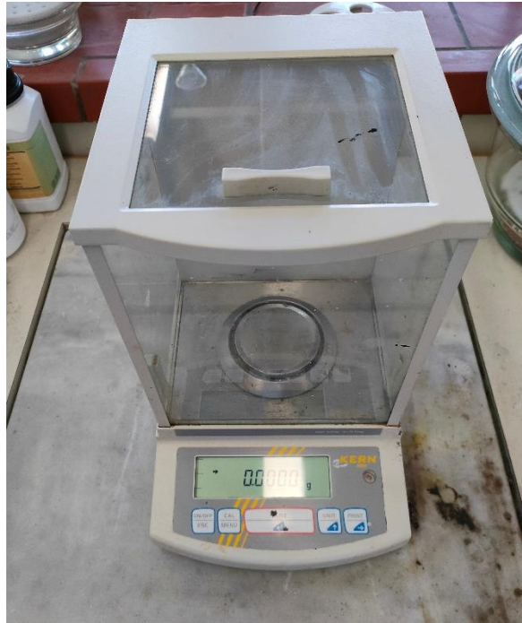
Εικόνα 9: Αναλυτικός ζυγός ακριβείας τεσσάρων δεκαδικών ψηφίων (g) για ζύγιση των φίλτρων.
