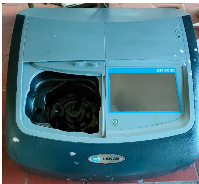
Εικόνα 12: Εργαστηριακό φωτόμετρο για την μέτρηση της απορρόφησης.
