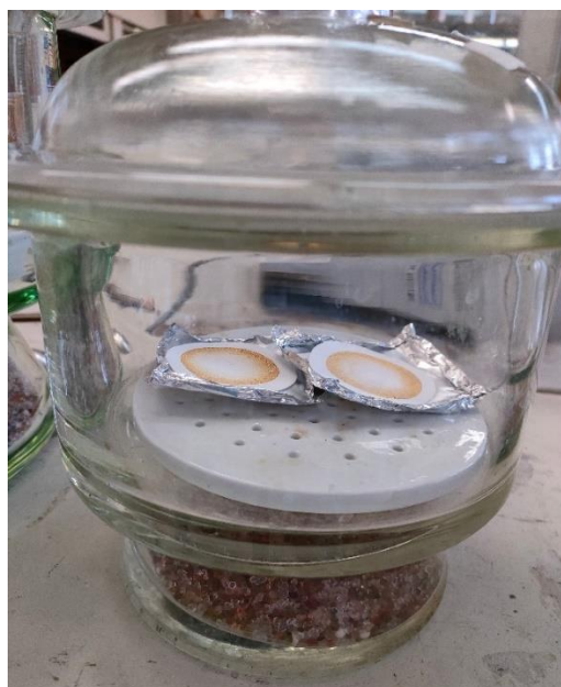
Εικόνα 8: Ξηραντήρας για την παραμονή των φίλτρων προς ζύγιση.
