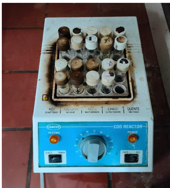
Εικόνα 11: Ειδικός φούρνος ( 150\text{ }^\circ\text{C} ) για την εξώθερμη αντίδραση μέτρησης COD.
