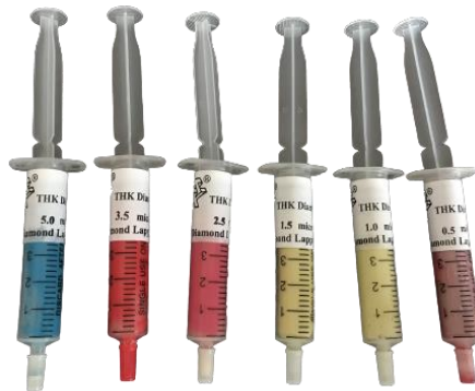
Εικόνα 114 - Οι πάστες διαμαντιού που χρησιμοποιήθηκαν για το γυάλισμα της κεραμικής στεφάνης, 5.0, 3.5, 2.5, 1.5, 1.0 & 0.5, micron.
