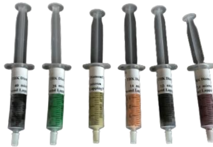
Εικόνα 113 - Οι πάστες διαμαντιού που χρησιμοποιήθηκαν για το γυάλισμα της κεραμικής στεφάνης, 40.0, 28.0, 20.0, 14.0, 10.0 & 7.0 micron.
