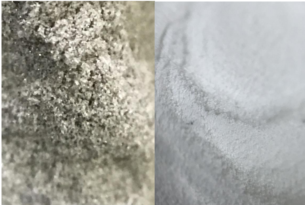
Εικόνα 81 - Η αλουμίνα αριστερά και η ζirkονία δεξιά σε μεγέθυνση.
