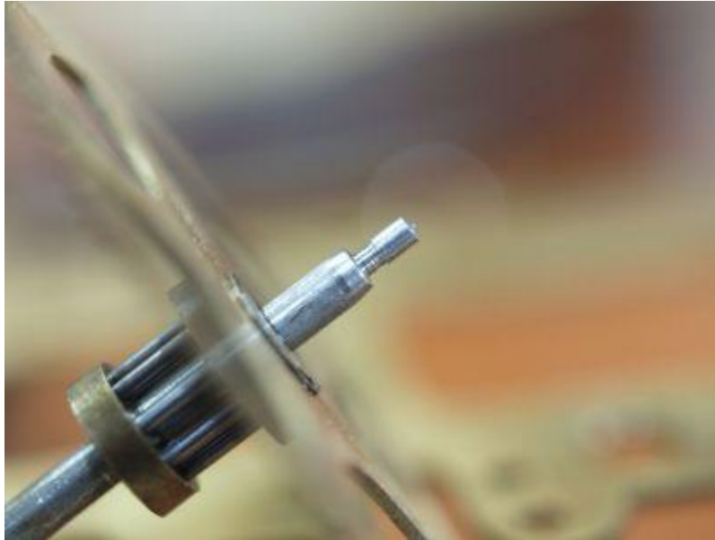
Εικόνα 17 - Ένα αρκετά φθαρμένο πιβό από την τριβή κατά τη στήριξη και την έλλειψη λίπανσης.
