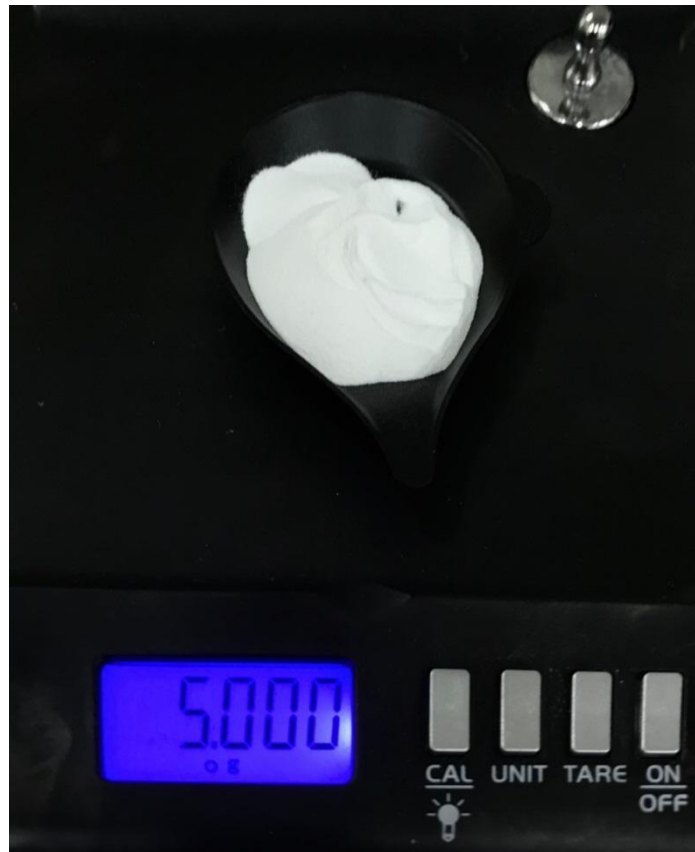
Εικόνα 86 - Μέτρηση 5 γραμμαρίων ζirkονίας σε ζυγό ακριβείας.
