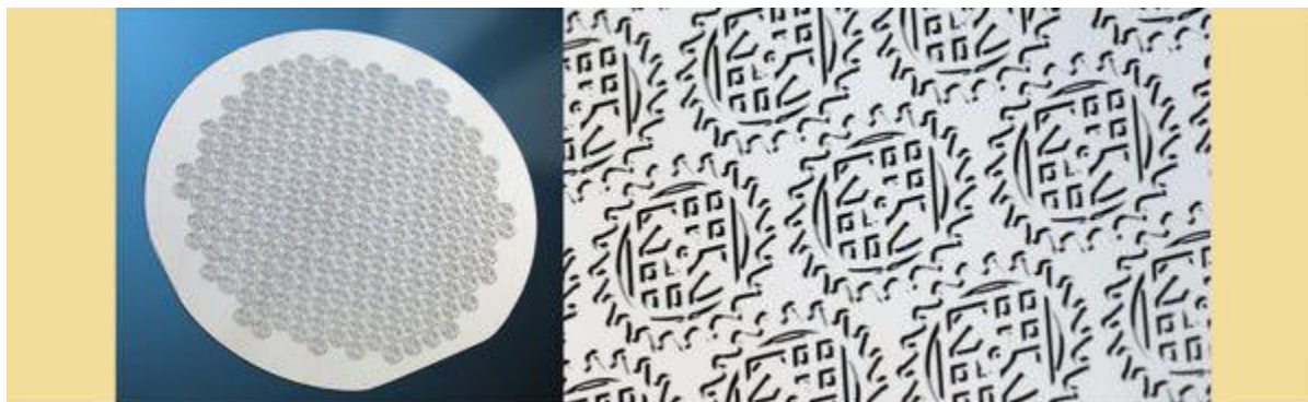
Εικόνα 20 - Πλάκα πυριτίου όπου έχουν τυπωθεί τροχοί διαφυγής με την τεχνική Drie.
