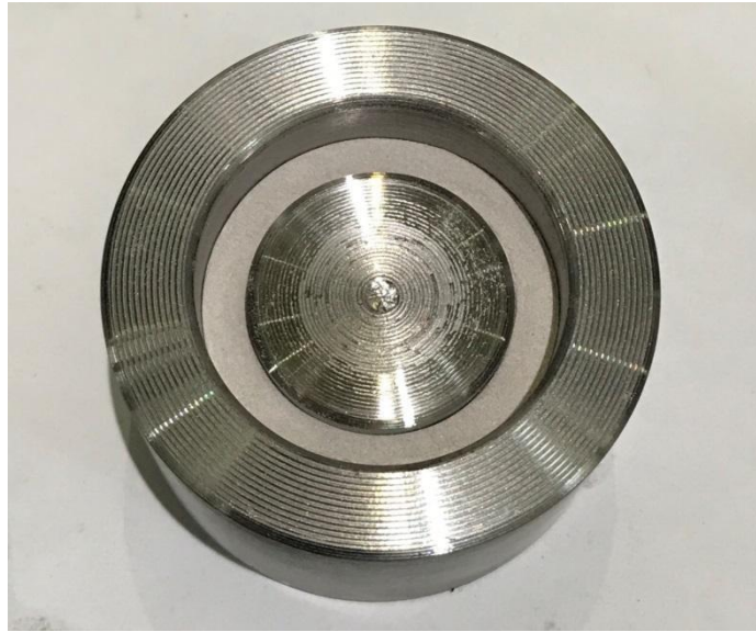
Εικόνα 96 - Το καλούπι μετά την πλήρωση με το κεραμικό μείγμα.
