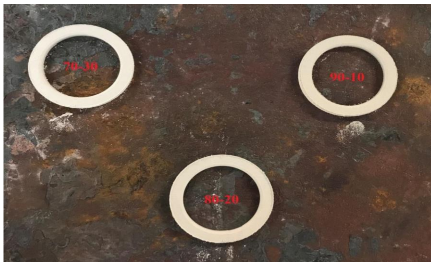
Εικόνα 100 - Οι τρεις στεφάνες διαφορετικών συστάσεων που παράχθηκαν μετά τη συμπίεση.
