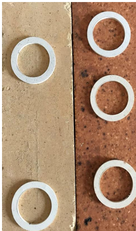
Εικόνα 104 - Το πυρότουβλο αλουμίνας, αριστερά πριν την έψηση και δεξιά μετά αυτή.
