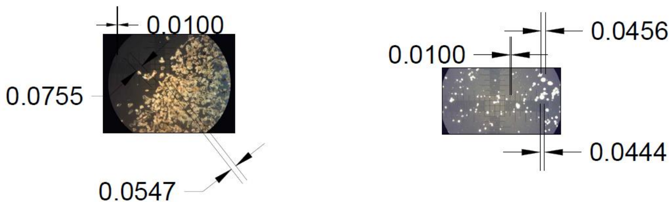
Εικόνα 85 - Μέτρηση των κόκκων μέσω προγράμματος AUTOCAD.
