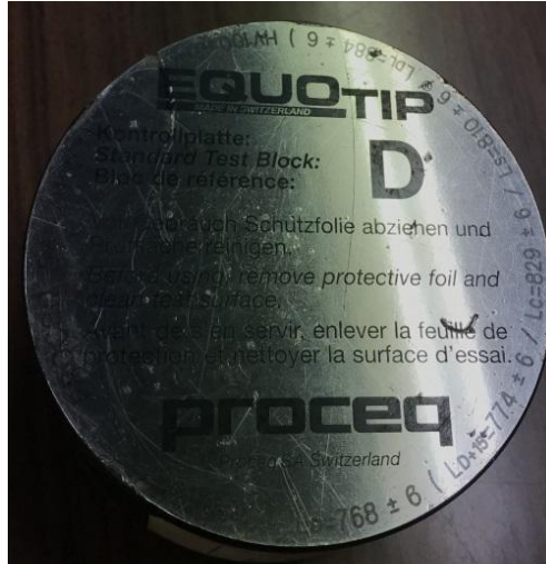
Εικόνα 120 - Βάση τοποθέτησης δοκιμίων/στεφάνων για την μέτρηση της σκληρότητας τους.
