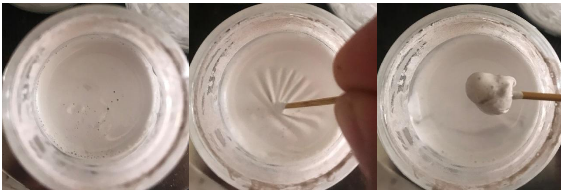
Εικόνα 92 - Αφαίρεση του PVA κατά τη θέρμανση-αφύγρανση του μείγματος.
