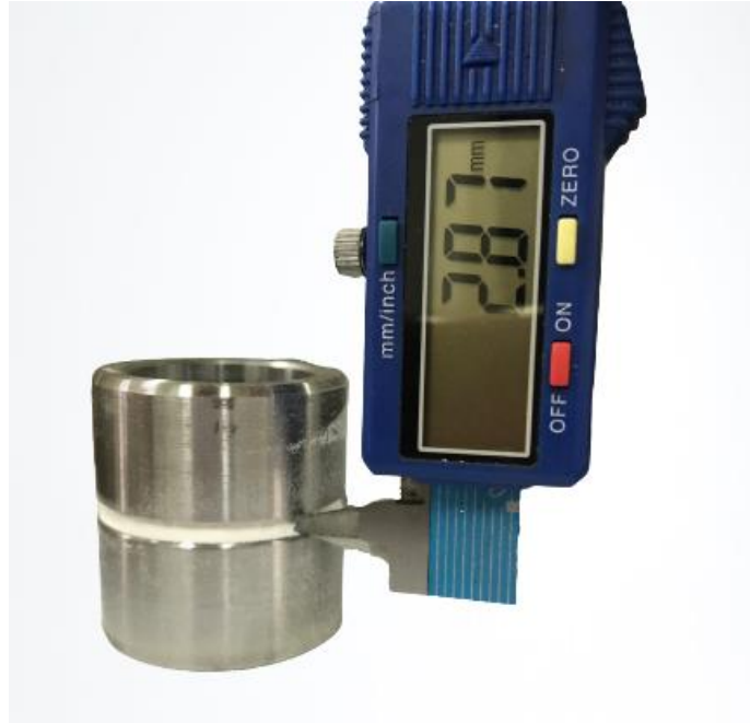
Εικόνα 88 - Μέτρηση ύψους για 5 γραμμάρια υλικού.
