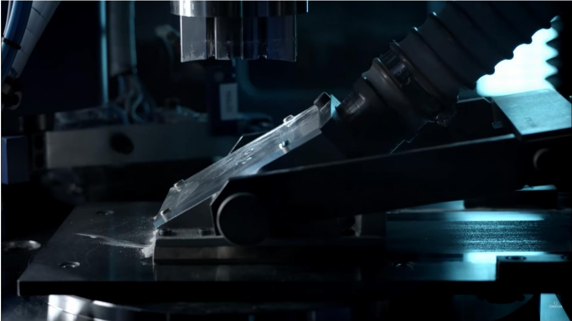
Εικόνα 67 - Καθαρισμός μήτρας κατασκευής κεραμικής θήκης.
