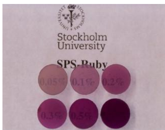
Εικόνα 18 - Η οπτική διαφάνεια της αλουμίνας με πρόσμιξη οξειδίου του χρωμίου στις διάφορες συγκεντρώσεις CrO 3 πυροσυσσωματωμένα στους 1350 βαθμούς Κελσίου για 5 λεπτά. α)0,05%(1,47mm),β)0,1%(1,44mm),γ)0,2%(1,37mm),δ)0,3%(1,46mm),ε)0,5%(1,35mm),στ)1,0%(1,36mm).
