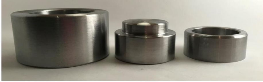
Εικόνα 77 - Τα τρία τμήματα του καλούπιού, αποσυναρμολογημένα.
