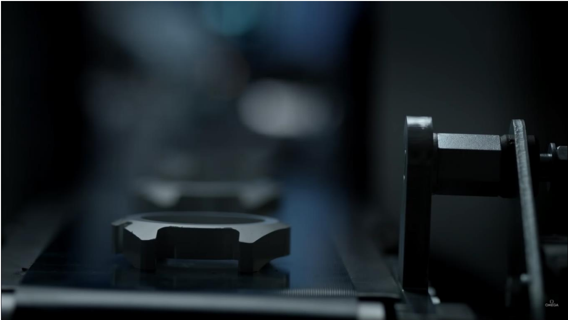
Εικόνα 71 - Προετοιμασία κεραμικής θήκης για έψηση.
