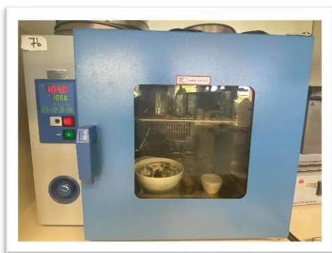
Εικόνα 9: Φούρνος Carbolite στους 102 - 105 °C – μέτρηση ολικών στερεών
