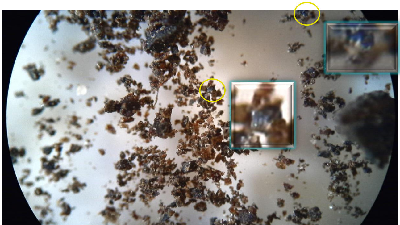
Εικόνα 42: Αποτέλεσμα μετά την ανάλυση μικροσκοπίου για τον αντιδραστήρα 6 που περιέχει Fe (III) (Blank)
