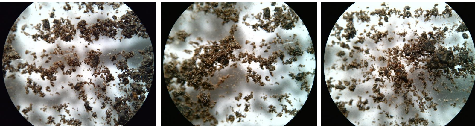
Εικόνα 29: Αποτέλεσμα μετά την ανάλυση μικροσκοπίου για τις φιάλες 7 & 8 που περιέχει Fe (0) μετά το BMP TEST
