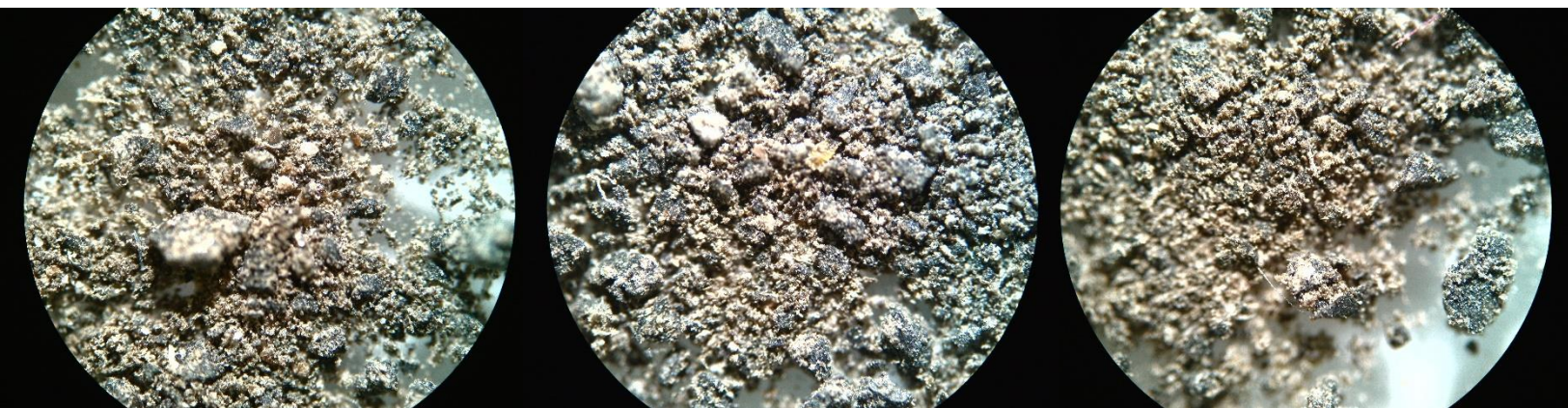
Εικόνα 31: Αποτέλεσμα μετά την ανάλυση μικροσκοπίου για την φιάλη 11 που δεν περιέχει Fe μετά το BMP TEST
