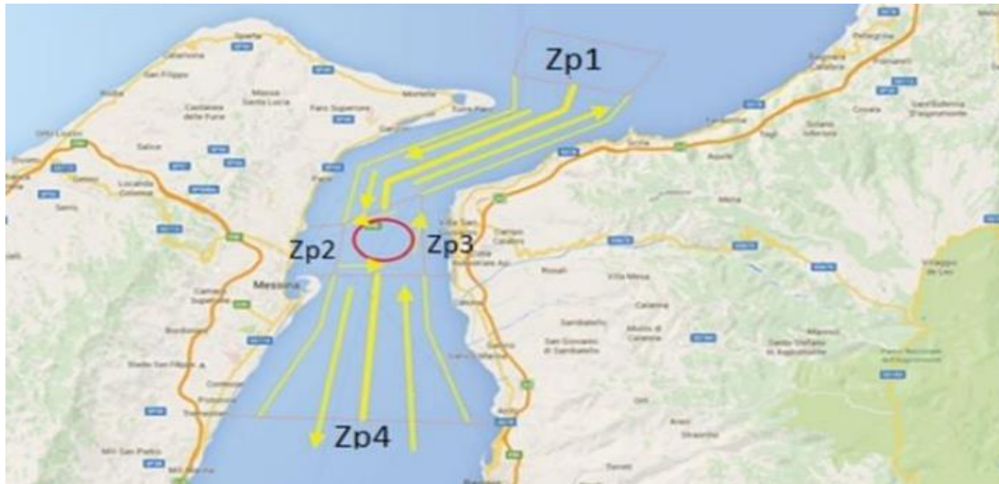
Εικόνα 7: Σύστημα Διαχωρισμού της Κυκλοφορίας (Traffic Separation Scheme) στο Στενό της Μεσσήνης στην Ιταλία (Cucinotta et al., 2017)
