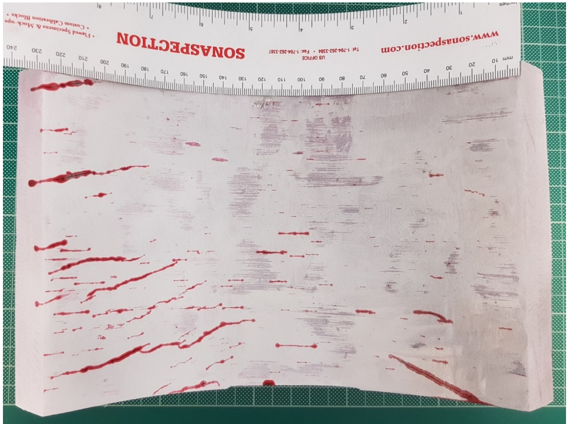
Εικόνα 3.4: Αποτελέσματα ελέγχων με ορατά διεισδυτικά υγρά
