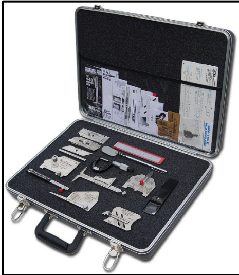
Εικόνα 2.3: Συλλογή εργαλείων επιθεώρησης συγκολλήσεων [31]
