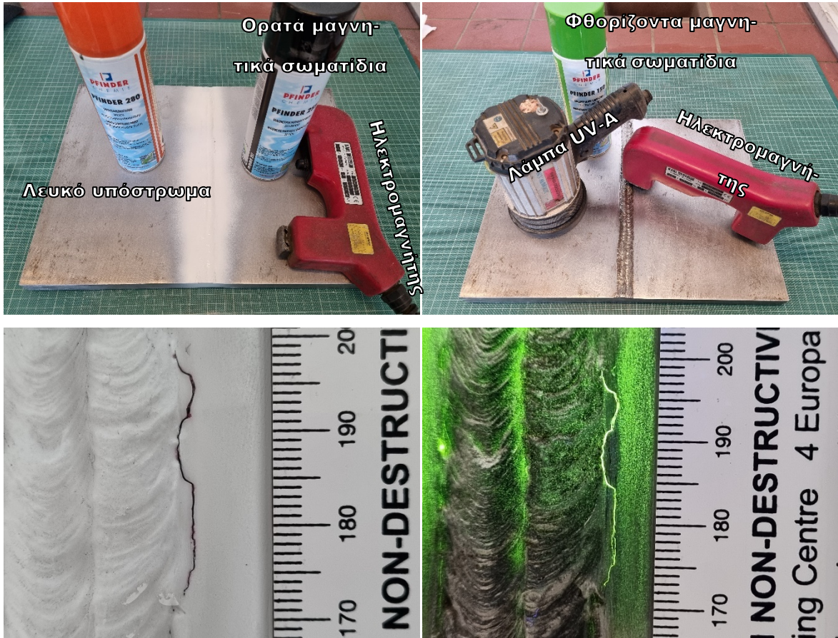
Εικόνα 2.13: Έλεγχος συγκόλλησης με ορατά μαγνητικά σωματίδια
