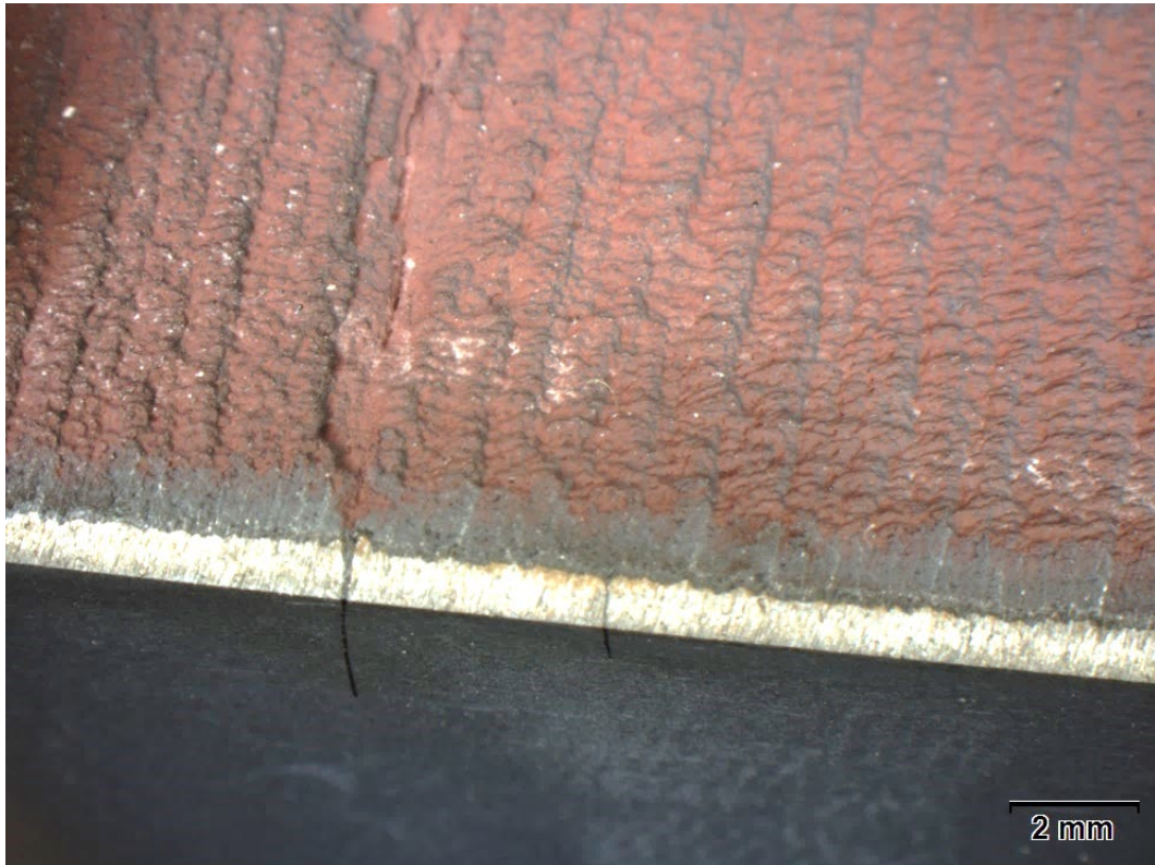
Εικόνα 6.3: Δοκίμιο 682/1/1/2, διαφορετικό σημείο, στερεοσκόπιο. Ρωγμές στην πλευρά ατμού (ID).
