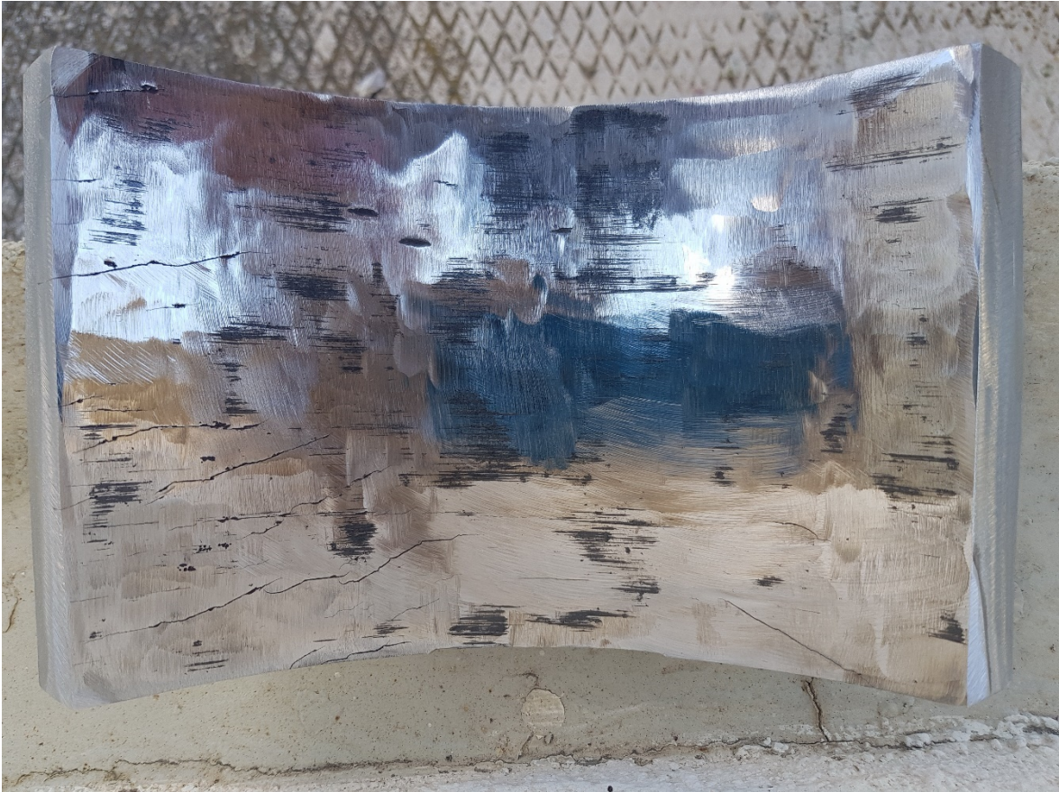
Εικόνα 3.3: Ύπαρξη μεγάλου πλήθους ρωγμών στην εσωτερική επιφάνεια του δοκιμίου
