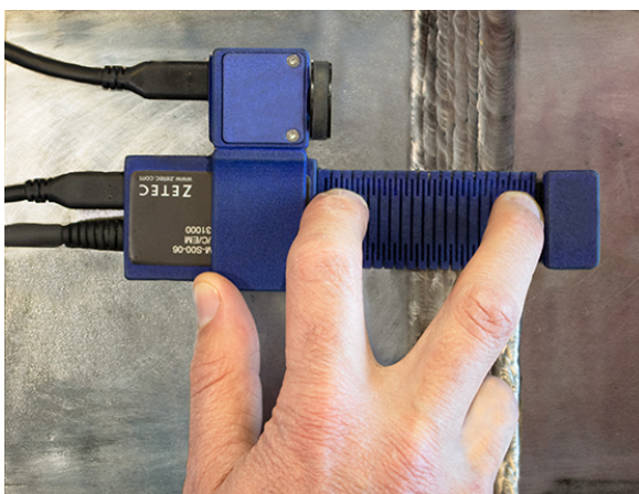
Εικόνα 2.19: Έλεγχος συγκολλήσεων με κεφαλή array [38]
