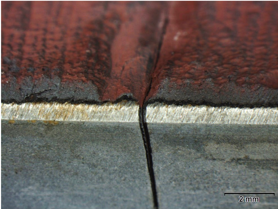
Εικόνα 6.2: Δοκίμιο 682/1/1/2. Εικόνα τομής στο σημείο διάρρηξης από το στερεοσκόπιο. Στο πάνω μέρος είναι η πλευρά ατμού (ID). Διακρίνεται μεγάλη ρωγμή.
