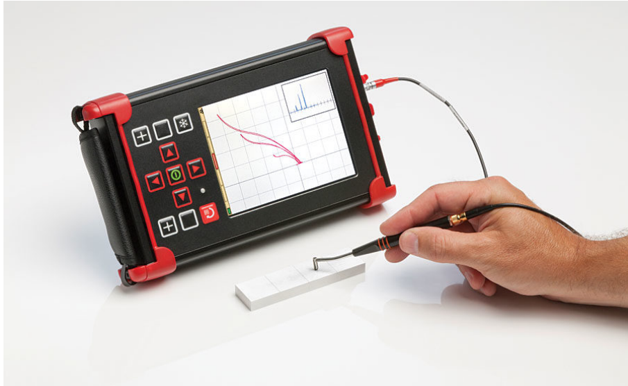
Εικόνα 2.18: Τυπικά σήματα ασυνεχειών σε όργανο δινορρευμάτων [37]
