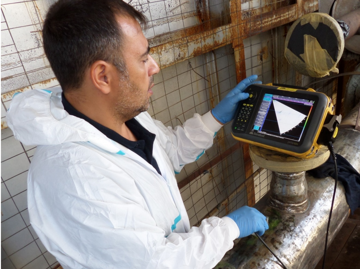
Εικόνα 3.16: Διενέργεια επιτόπιων ΜΚΕ με τη μέθοδο Phased Array
