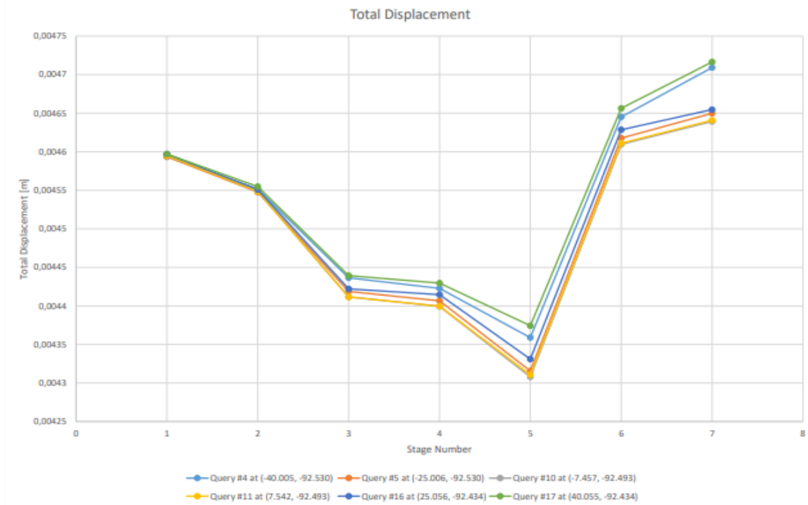
Διάγραμμα 7. 5: Διάγραμμα συνολικών μετατοπίσεων σε διακριτά σημεία στη μέση των παρειών των δεξαμενών με διατομή 15X30
