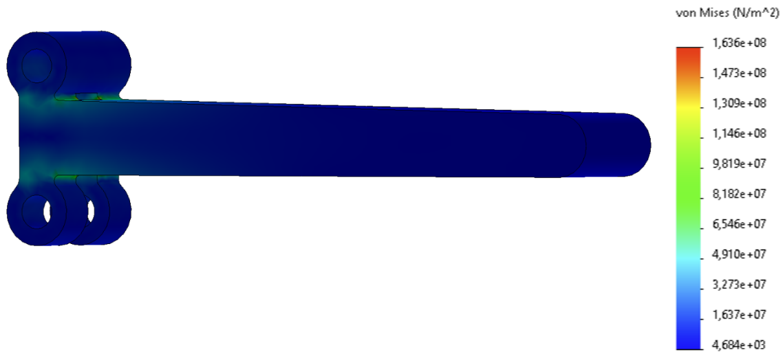
Εικόνα 64 Αναπτυσσόμενες Τάσεις 3ου Συνδετικού Μέλους
