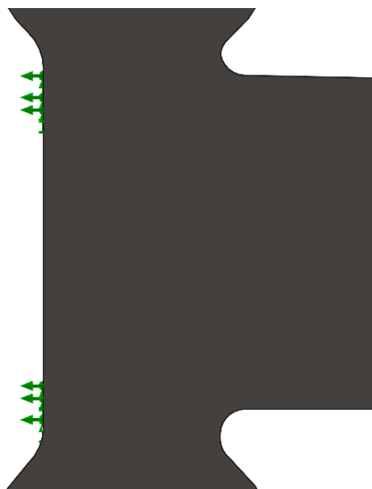
Εικόνα 61 Εφαρμοζόμενη Οριακή Συνθήκη για το 3ο Συνδετικό Μέλος
