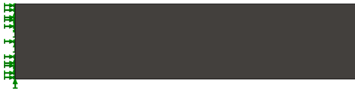
Εικόνα 59 Εφαρμοζόμενη Οριακή Συνθήκη για 1ο Συνδετικό Μέλος
