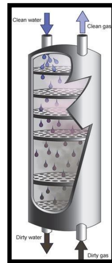
Εικόνα 22: Σχηματική αναπαράσταση στήλης απορρόφησης με δίσκους [163]
