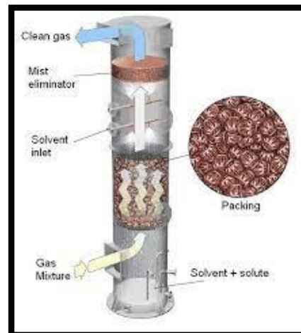
Εικόνα 23: Σχηματική αναπαράσταση στήλης απορρόφησης με πληρωτικό υλικό [164]
