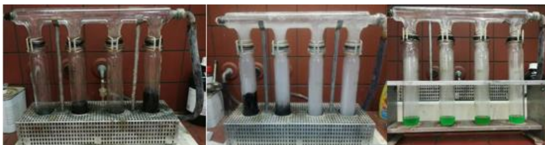
Εικόνα 15: Επιμέρους στάδια στη συσκευή καύσης Kjeldahl
