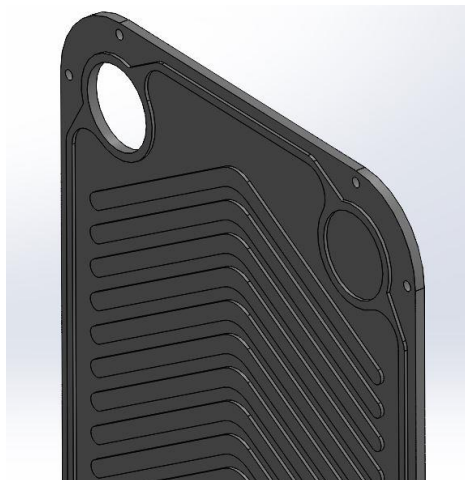
Εικόνα 6.7: Κενό στο άνω μέρος της πλάκας (είσοδος νερού)
