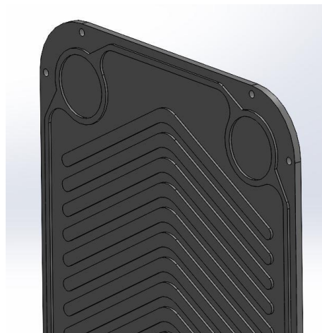
Εικόνα 6.9: Έλλειψη κενών στο άνω μέρος της πλάκας
