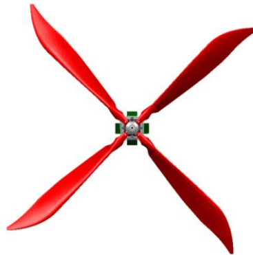
Εικόνα 3.13: Πτερύγια δρομέα αεροσκάφους
