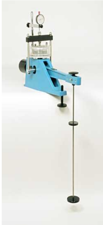
Εικόνα 2-1 Πειραματική διάταξη της δοκιμής μονοδιάστατης συμπίεσης (πηγή: διαδίκτυο)
