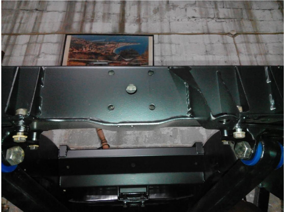
Εγκατάσταση A frame πίσω άκαμπτου άξονα
