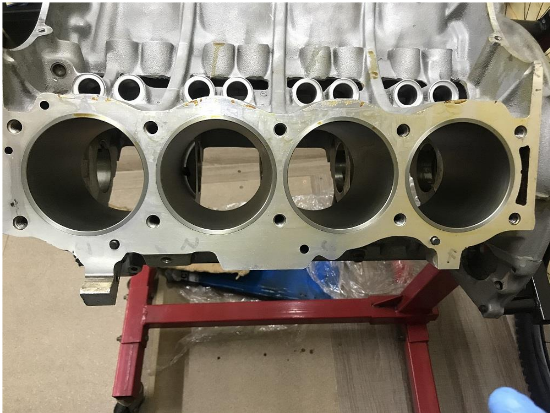
Τοποθέτηση των Tshaped liners
