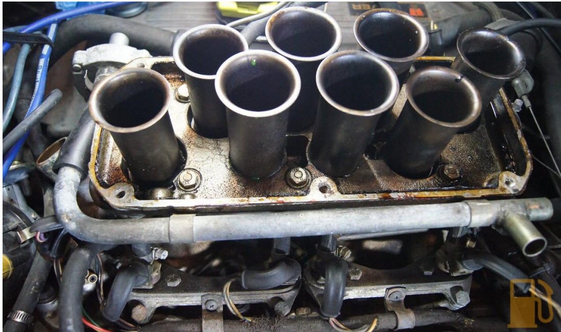
Εργοστασιακοί αυλοί εισαγωγής αέρα
