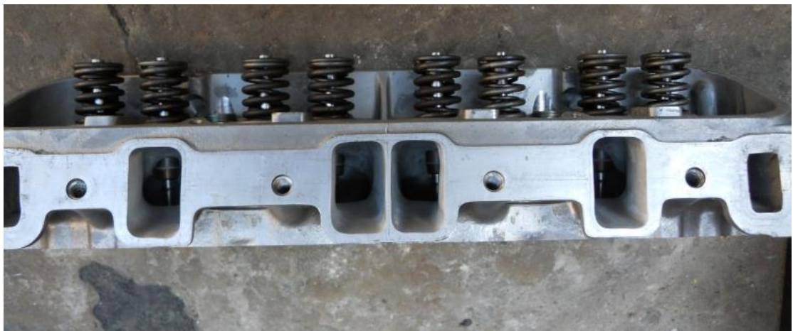
Τελικοί οχετοί εισαγωγής αέρα μετά τις εργασίες αύξησης της διατομής τους
