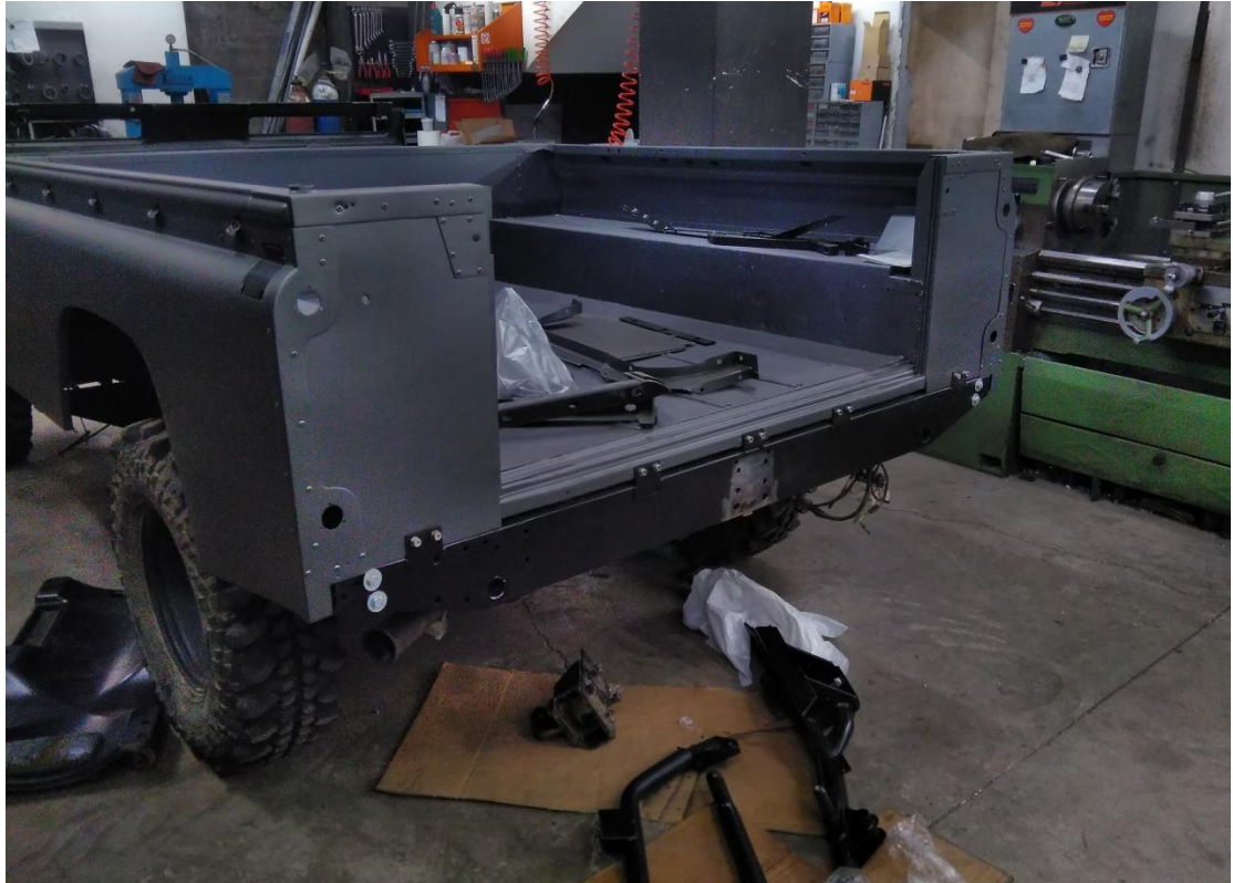
Αύξηση πλάτους πίσω προφυλακτήρα
