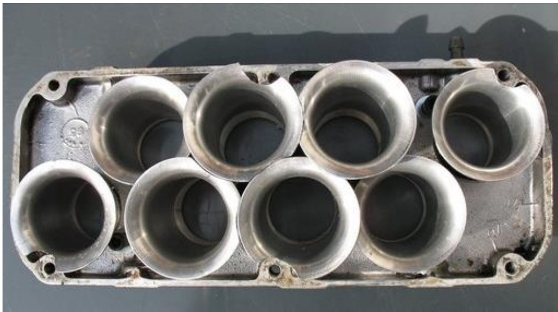
Αυξημένης διατομής αυλοί εισαγωγής αέρα
