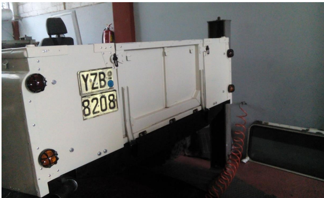
Αρχική προσπάθεια, όπου αλλοιώνονται αρκετά οι αναλογίες της θύρας φόρτωσης με τα σταθερά στοιχεία του πίσω μέρους του οχήματος, σε σχέση με το εργοστασιακό όχημα.
