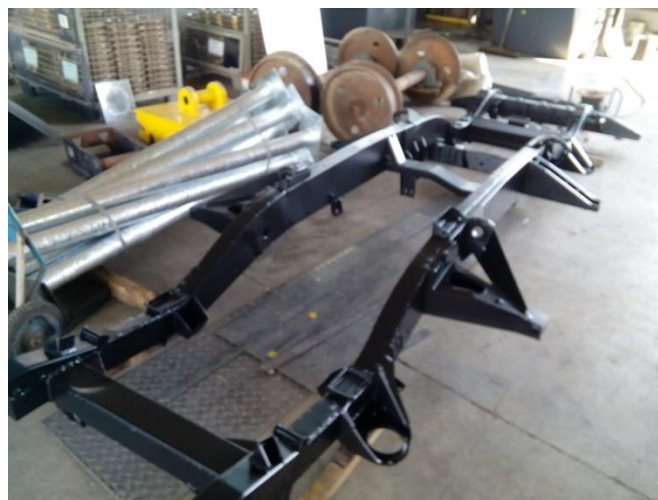
Ολοκλήρωση κατεργασιών αμβολής ενίσχυσης και βαφής πλαισίου
