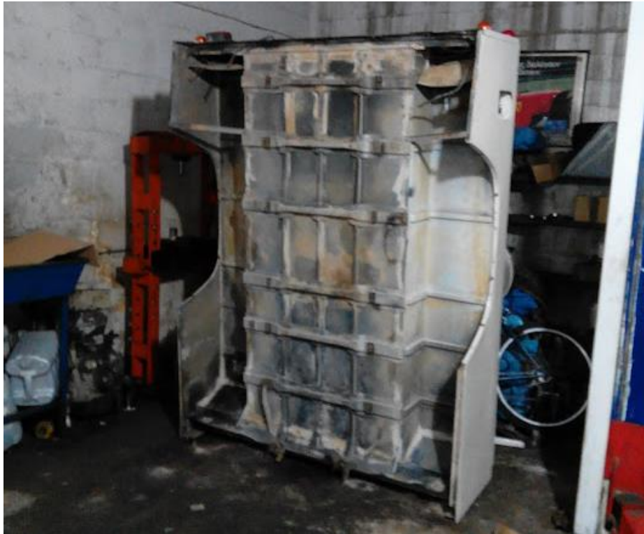
Αφαίρεση του εργοστασιακού αλουμιένιου τμήματος του αμαξώματος που αποτελεί τον χώρο φόρτωσης
