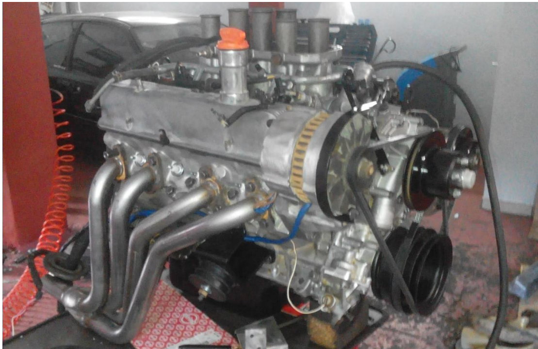
Τοποθέτηση ανοξείδωτων πολλαπλών εξάτμισης
