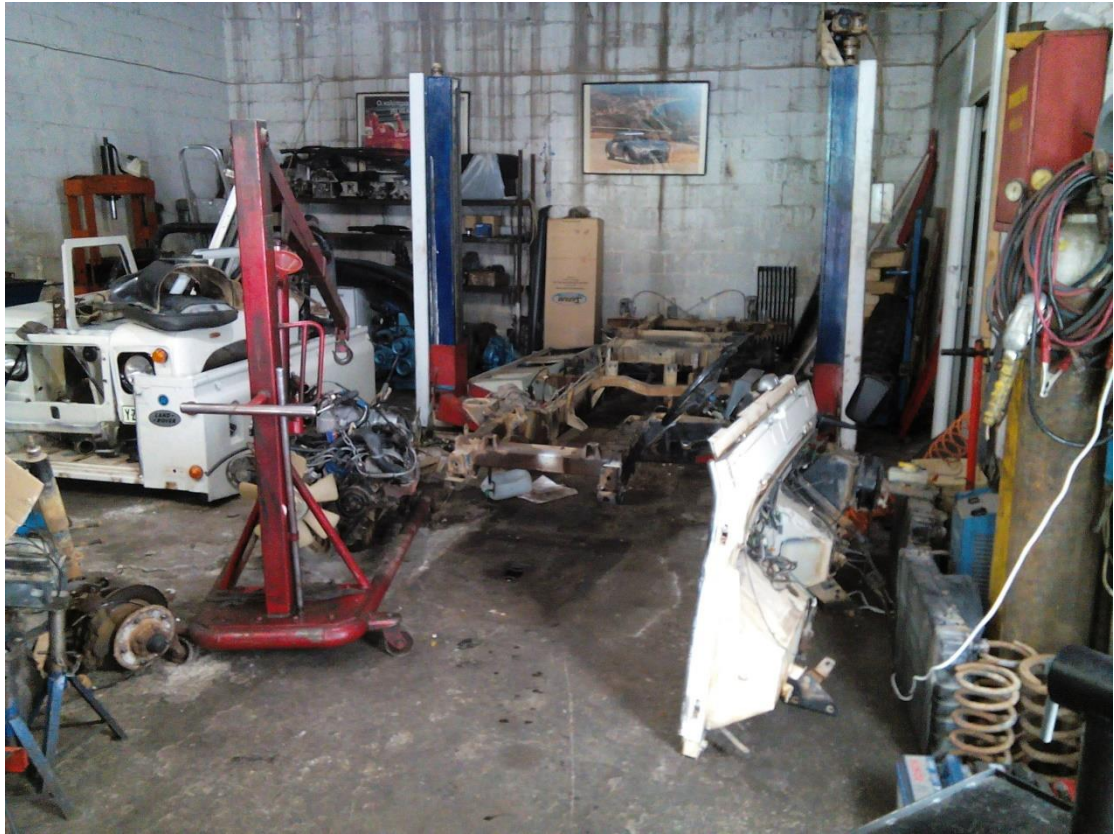
Πλήρης απομάκρυνση όλων των εξαρτημάτων από το πλαίσιο
