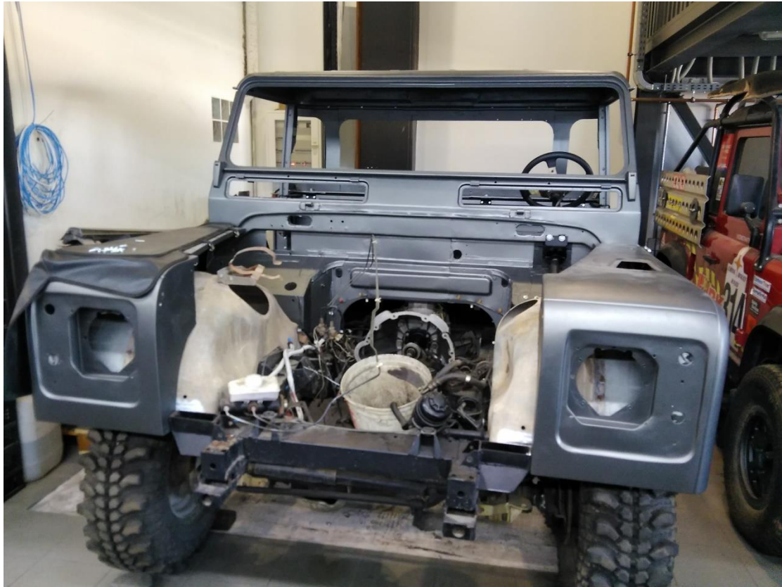
Προετοιμασία παράλληλα για εγκατάσταση κινητήρα
