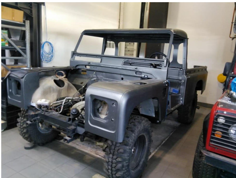
Εγκατάσταση προσαρμοσμένων εμπρός θόλων τροχών και οροφής
