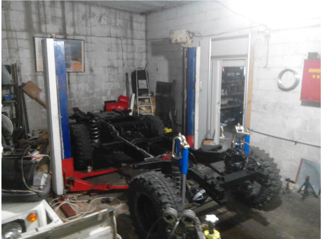
Και συναρμολόγηση κινούμενου πλαισίου
