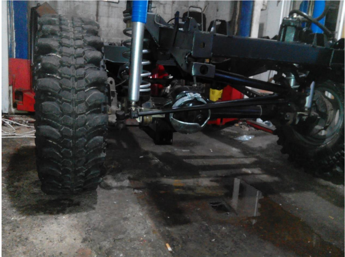
Τοποθέτηση εμπρόσθιου άξονα και ανάρτησης
