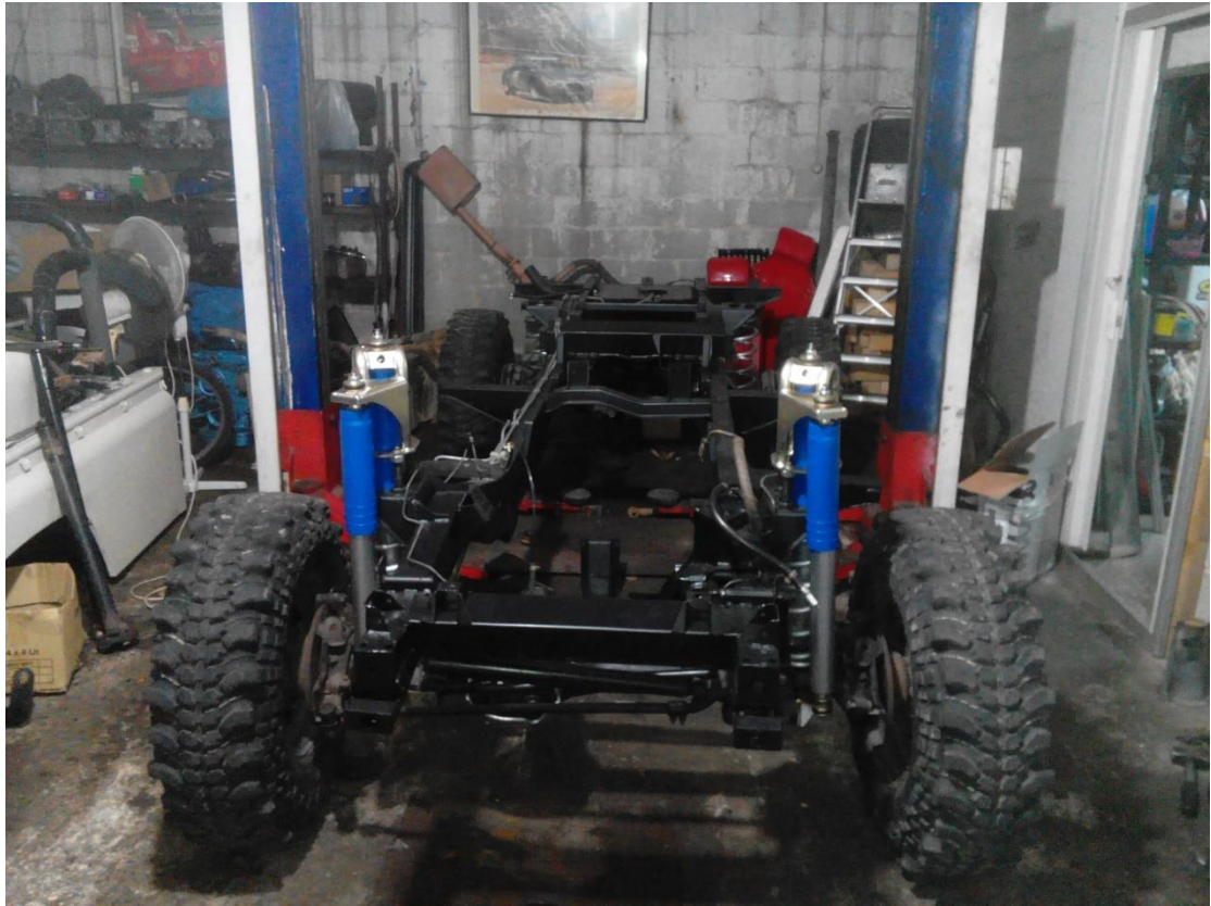
Ολοκλήρωση συναρμολόγησης rolling chassis
