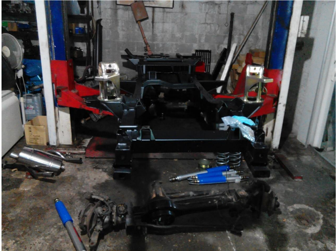
Συναρμολόγηση πλαισίου και αξόνων
