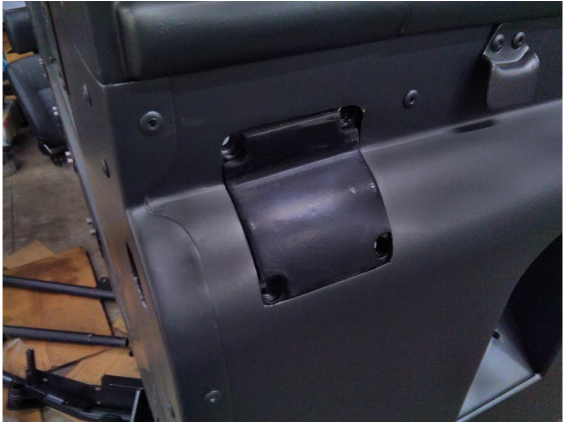
Τοποθέτηση βάσεων κλωβού ασφαλείας
