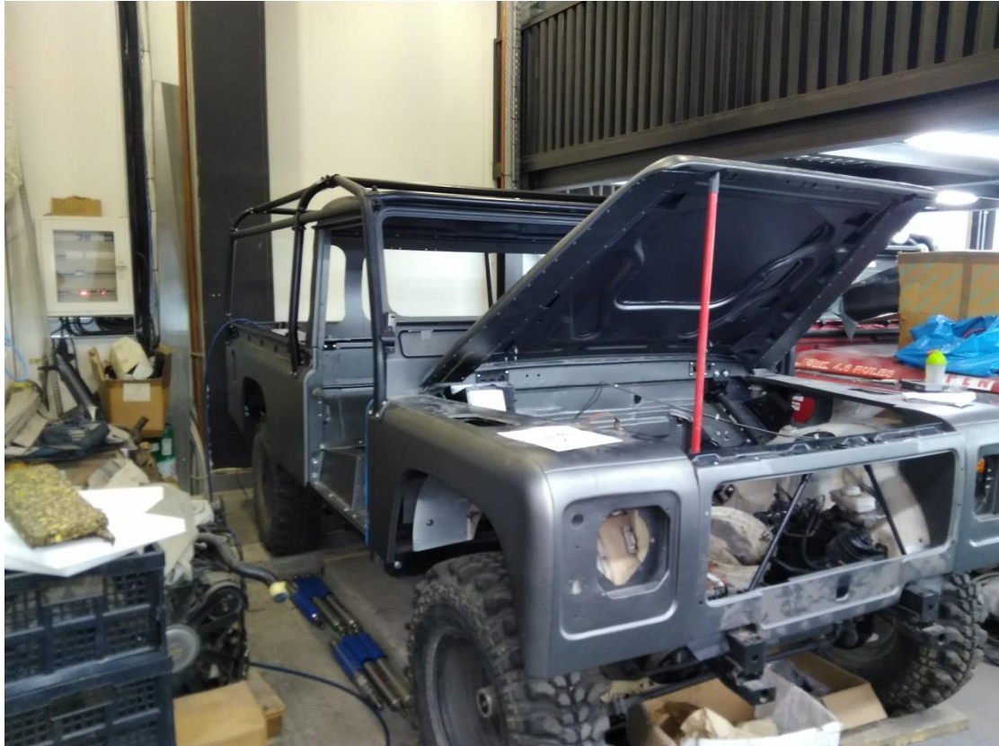
Ολοκλήρωση κλωβού ασφαλείας και καπό κινητήρα
