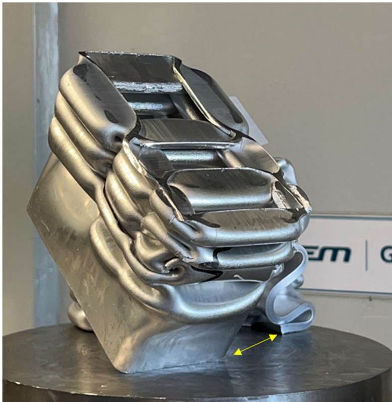
Εικόνα 34 Συμπιεσμένο δοκίμιο w- w/o SSHT με χρόνο τεχνητής γήρανσης 48 ωρών.
