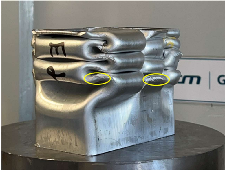
Εικόνα 39 Συμπιεσμένο δοκίμιο ac-w/o SSHT με χρόνο τεχνητής γήρανσης 4 ωρών.
