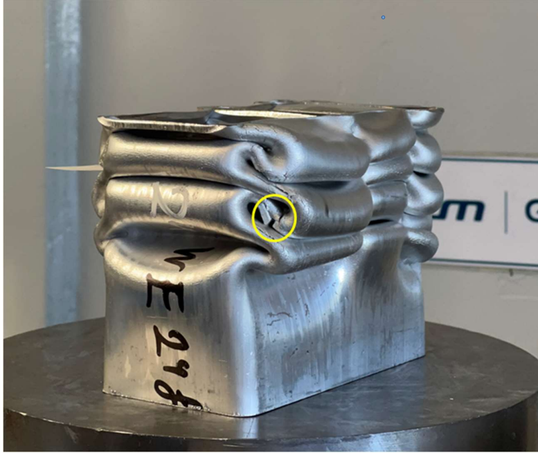
Εικόνα 33 Συμπιεσμένο δοκίμιο w- w/o SSHT με χρόνο τεχνητής γήρανσης 24 ωρών.
