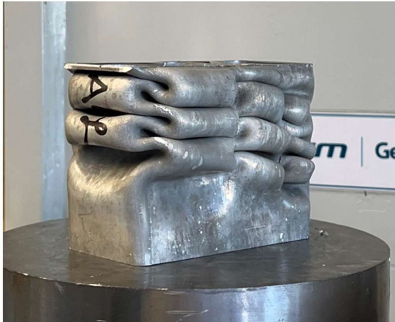
Εικόνα 43 Συμπιεσμένο δοκίμιο α- SSHT με χρόνο τεχνητής γήρανσης 4 ωρών.
