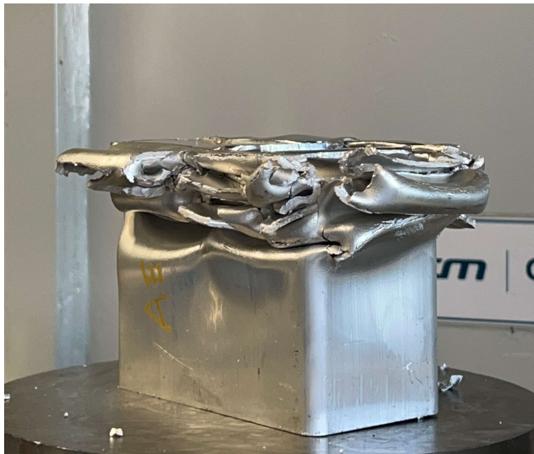
Εικόνα 40 Συμπιεσμένο δοκίμιο ac-w/o SSHT με χρόνο τεχνητής γήρανσης 8 ωρών.
