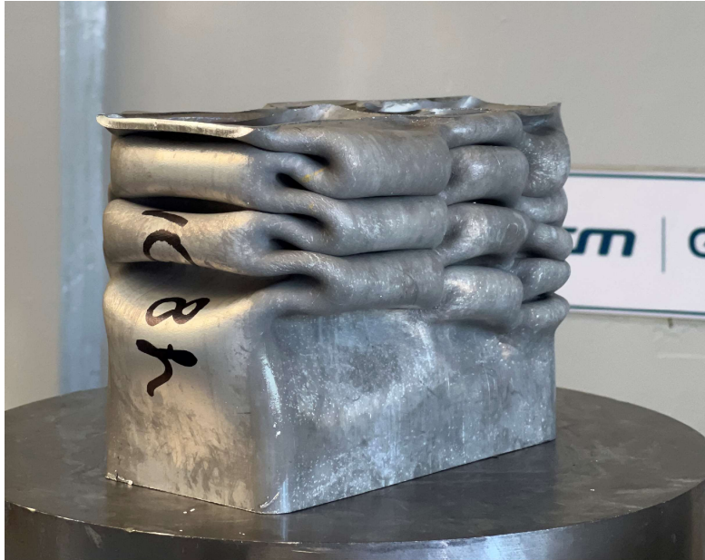
Εικόνα 36 Συμπιεσμένο δοκίμιο wg-SSHT με χρόνο τεχνητής γήρανσης 8 ωρών.
