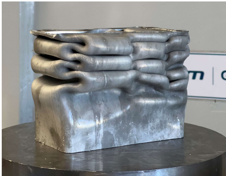
Εικόνα 37 Συμπιεσμένο δοκίμιο wg-SSHT με χρόνο τεχνητής γήρανσης 24 ωρών.
