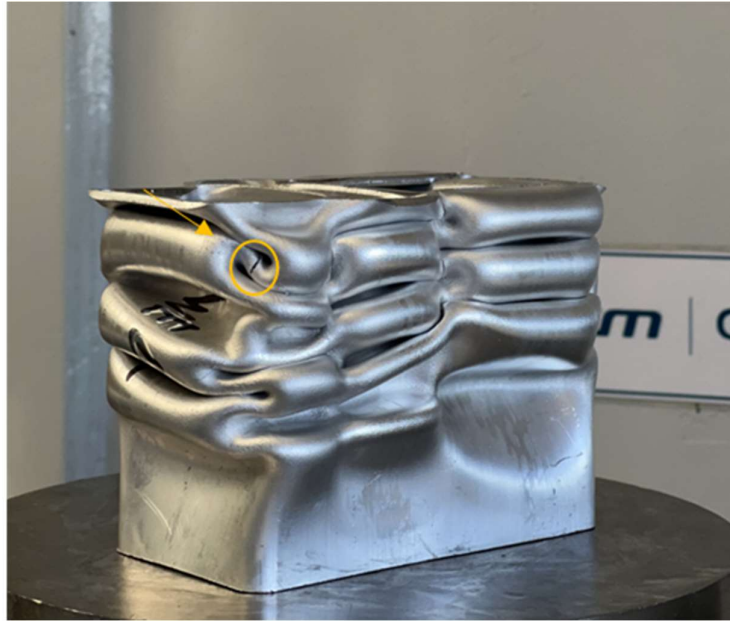
Εικόνα 31 Συμπιεσμένο δοκίμιο wq- w/o SSHT με χρόνο τεχνητής γήρανσης 4 ωρών
