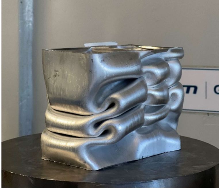
Εικόνα 29 Συμπιεσμένο δοκίμιο wq-as received
