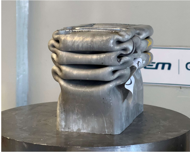
Εικόνα 38 Συμπιεσμένο δοκίμιο wa-SSHT με χρόνο τεχνητής γήρανσης 48 ωρών.
