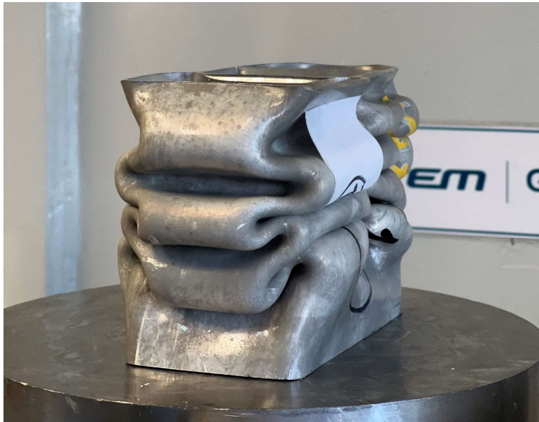
Εικόνα 35 Συμπιεσμένο δοκίμιο wq- SSHT με χρόνο τεχνητής γήρανσης 4 ωρών.
