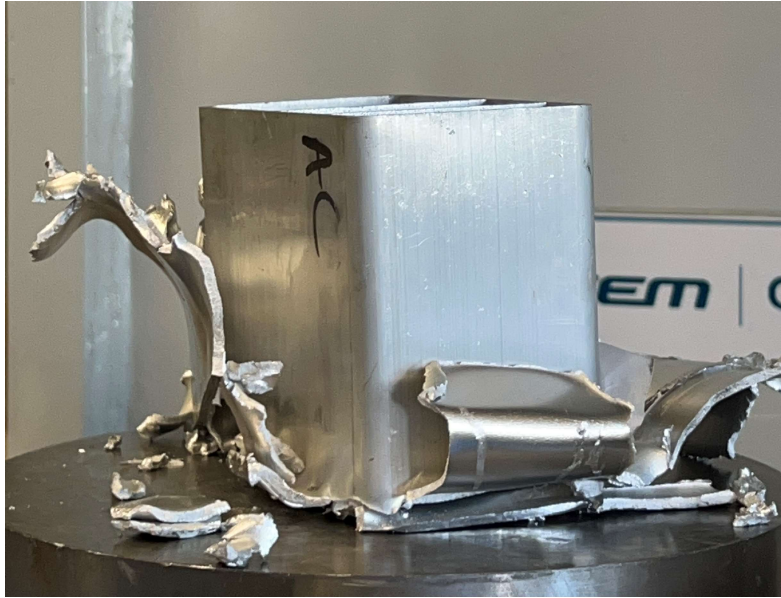
Εικόνα 41 Συμπιεσμένο δοκίμιο ac-w/o SSHT με χρόνο τεχνητής γήρανσης 24 ωρών.
