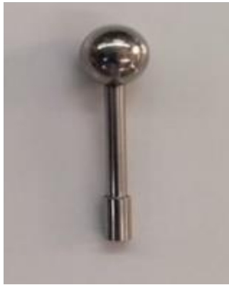
Εικόνα 9: Probe (αισθητήρας δειξίδυσης) αναλυτή υφής κατά την δοκιμή συμπίεσης
