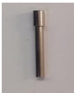
Εικόνα 7: Probe (αισθητήρας διείσδυσης) αναλυτή υφής κατά την δοκιμή θραύσης
