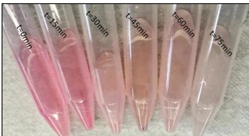
Εικόνα 4. 10: Σταδιακός αποχρωματισμός 5 mL διαλύματος ροδαμίνης 6G συγκέντρωσης 3 ppm με χρήση νανοσωματιδίων ZnO (5 mg).
