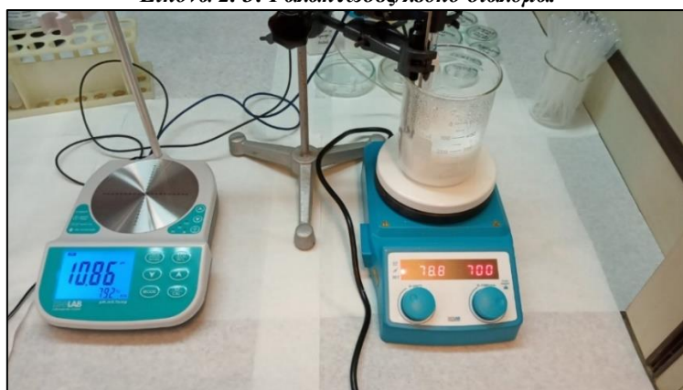
Εικόνα 2. 4: Θέρμανση στους 80^\circ\text{C} και ανάδευση σε 700 rpm.
