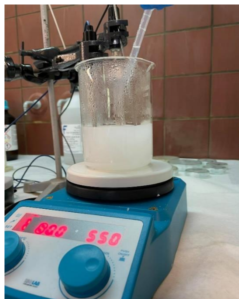
Εικόνα 2. 2: Στάγδην προσθήκη διαλύματος \text{NaOH} (2 M).
