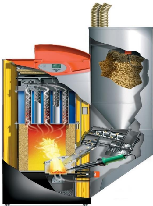
Σχήμα 31. Λέβητας Pellet σε τομή [28].
