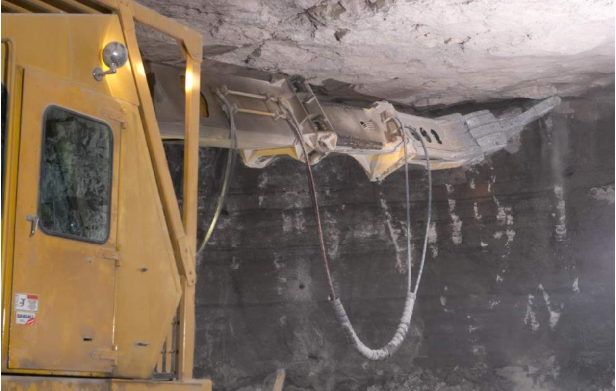
Εικόνα 63 Ξεσκαρώτης σε δράση ( http://www.gradall.com )
