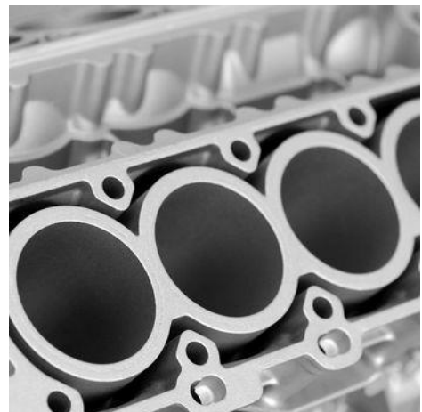
Εικόνα 2 Μέρος κινητήρα εσωτερικής καύσης με επιμετάλλωση κράματος Ni ( www.helmut-fischer.com )
