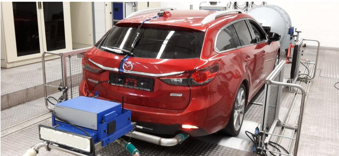
Εικόνα 5.1: Έλεγχος εκπομπών επιβατικού αυτοκινήτου επάνω σε δυναμόμετρο πλαισίου
