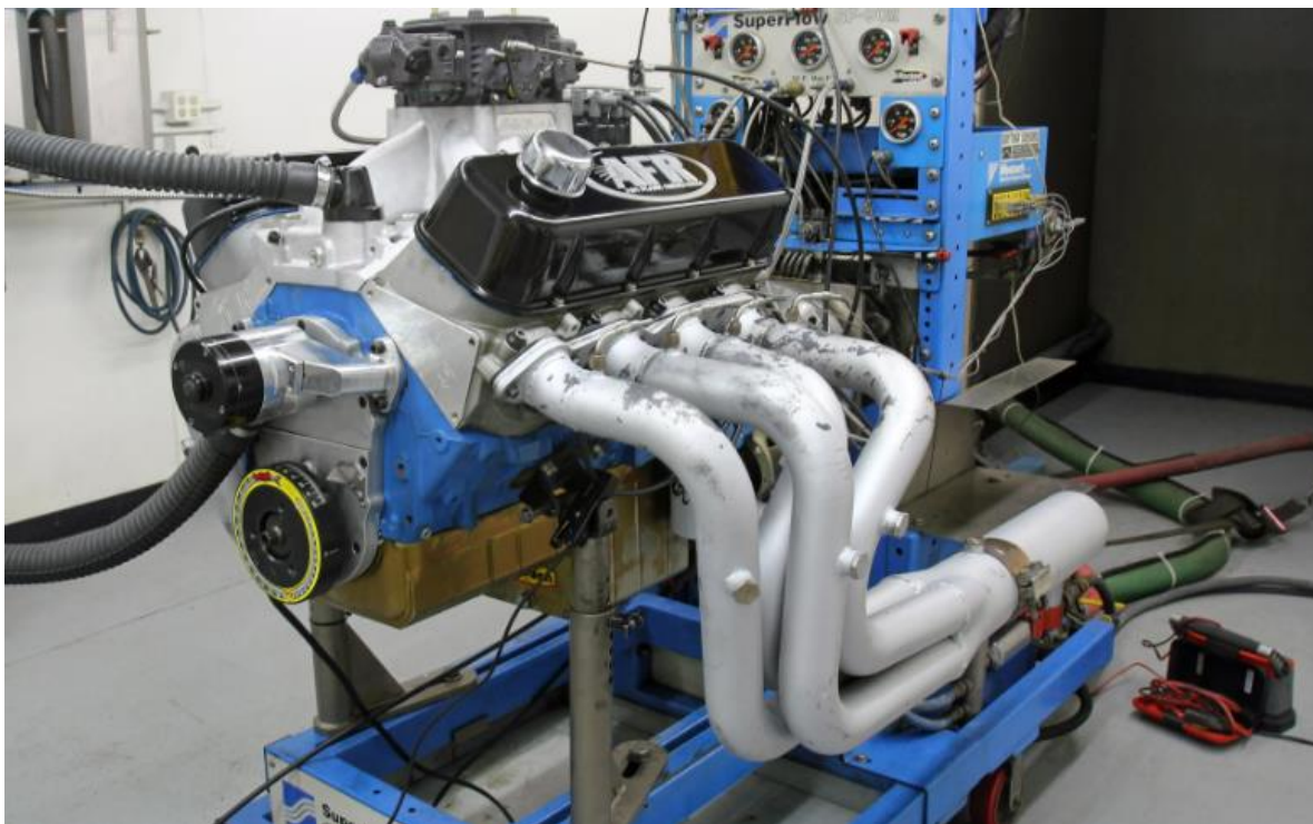
Εικόνα 5.2: Κινητήρας προσαρμοσμένος επάνω σε δυναμόμετρο
