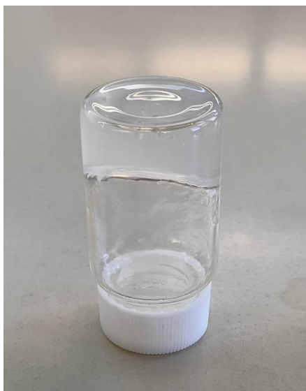
Εικόνα 10: Υδρογέλη αλγινικού διασυνδεδεμένη με NADES χλωριούχου χολίνης-κιτρικού οξέος
