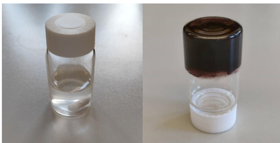
Εικόνα 7: Διάλυμα αλγινικού νατρίου (αριστερά) και υδρογέλη αλγινικού με νανοσωματίδια αργύρου με τη χρήση εκχυλίσματος φύλλων ελιάς μετά το πέρας της ανάδευσης (δεξιά)
