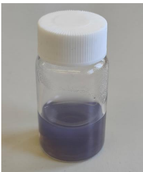
Εικόνα 14: Διάλυμα αλγινικού με νανοσωματίδια αργύρου, που παράχθηκε ακολουθώντας την μεθοδολογία των Pandey και Ramontja
