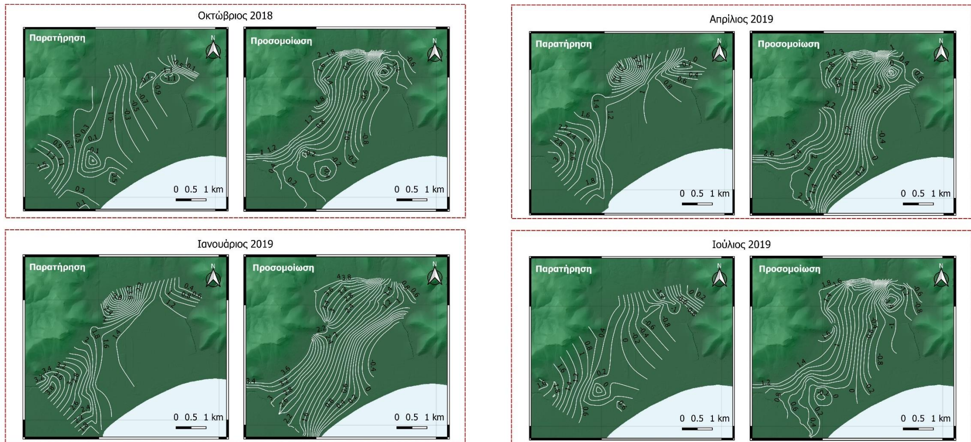
Σχήμα 5.6 Κατανομή παρατηρημένου και προσομοιωμένου υδραυλικού φορτίου στον κοκκώδη σχηματισμό του Μαραθώνα
