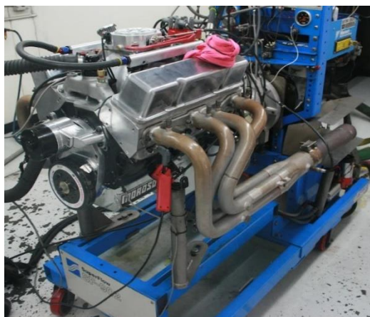
Σχήμα 3.2: Κινητήρας βαρέος τύπου συνδεδεμένος με δυναμόμετρο δοκιμής κινητήρων
