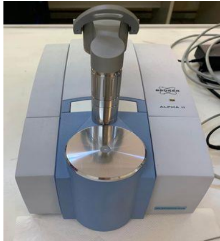
Εικόνα 34. Συσκευή Bruker, Alpha II για την λήψη φασμάτων FTIR.
