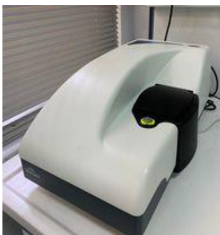
Εικόνα 33. Συσκευή ZetaSizer Nano ZS, για τις μετρήσεις DLS.
