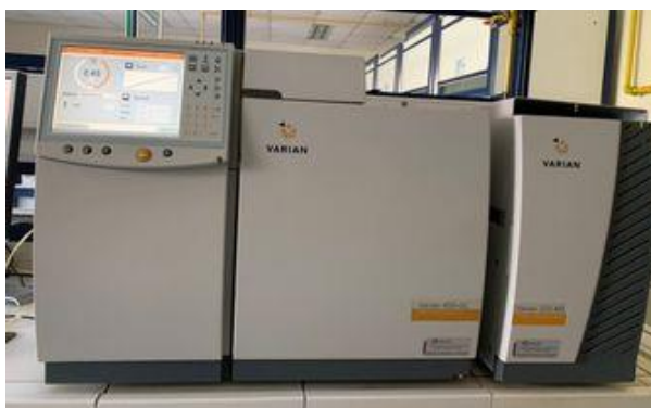
Εικόνα 32. Αέριος χρωματογράφος συζευγμένος με φασματόμετρο μάζας, Mass Spectrometer Varian 220-MS.
