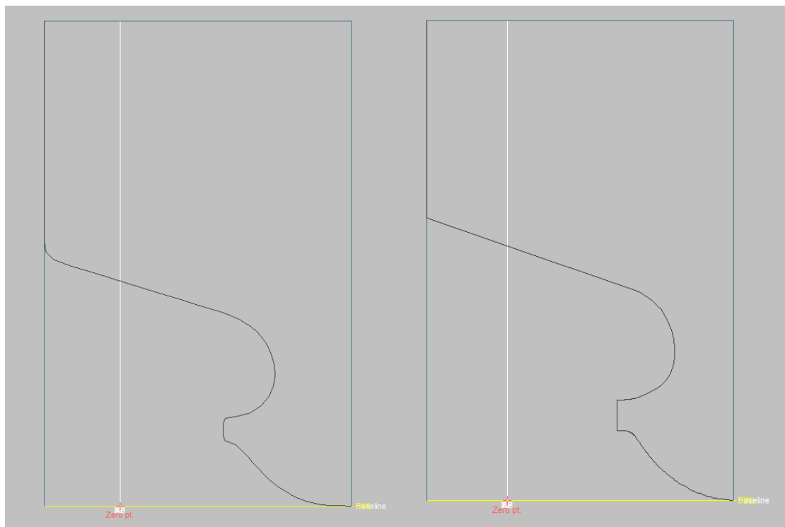
Εικόνα 3. 5: Προφίλ πρύμνης υπό μελέτη πλοίου πριν και μετά την επεξεργασία του
