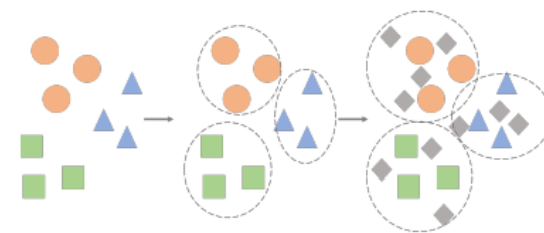
Σχήμα 2.3: Ημιεπιβλεπόμενη Μάθηση, τα δείγματα ταξινομούνται σε συστάδες και στην συνέχεια ταξινομούνται με χρήση μικρού όγκου δεδομένων εκπαίδευσης.[45]
