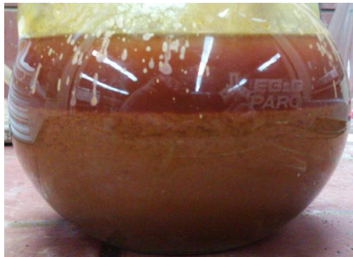
Εικόνα 3. 6 Παραμονή μετά του μητρικού υγρού, καθίζηση στερεών.
