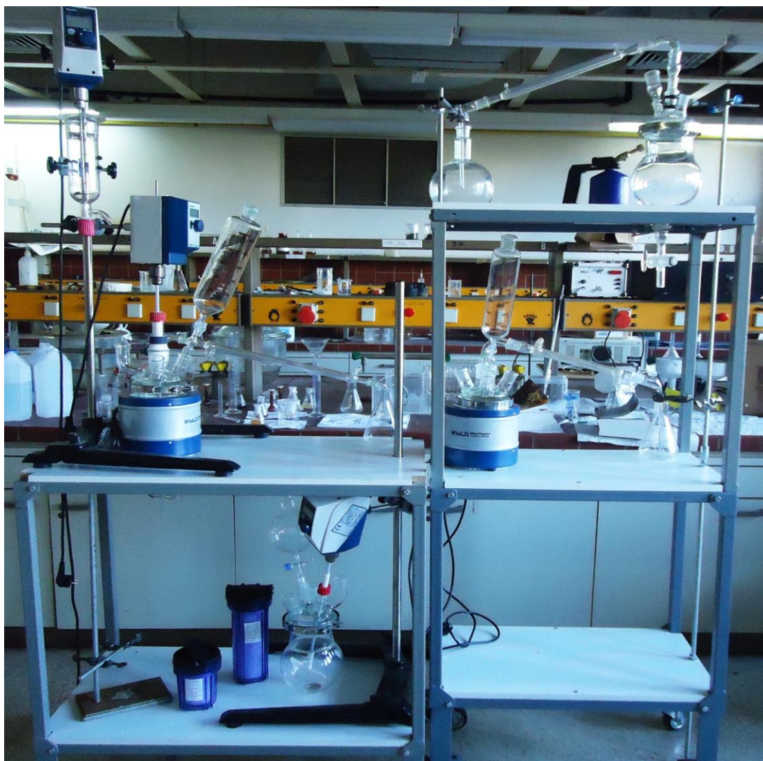
Εικόνα 4. 1 Άποψη πιλοτικής γραμμής αξιοποίησης ερυθράς ιλύος.
