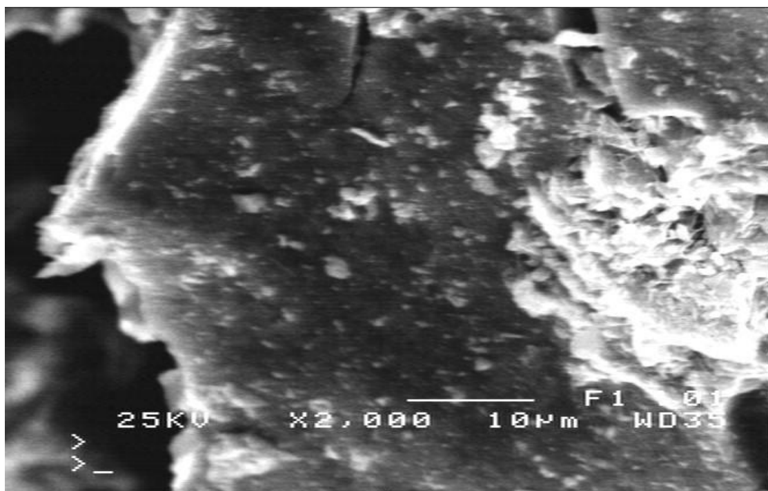
Εικόνα 3. 15 Εικόνα ηλεκτρονικού μικροσκοπίου ιζήματος σιδήρου X2000.
