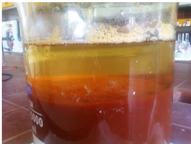
Εικόνα 3. 12 Παραμονή ιζήματος σιδήρου με το μητρικό υγρό- καθίζηση ιζήματος.
