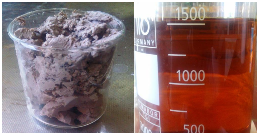
Εικόνα 3. 7 (αριστερά) στερεά αδιάλυτα της χώνευσης, (δεξιά) υγρό διάλυμα χλωριούχων.
