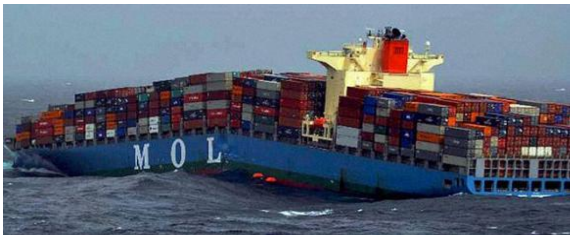
Εικόνα 4: Αστοχία του πλοίου MOL Comfort λόγω ρήγματος
