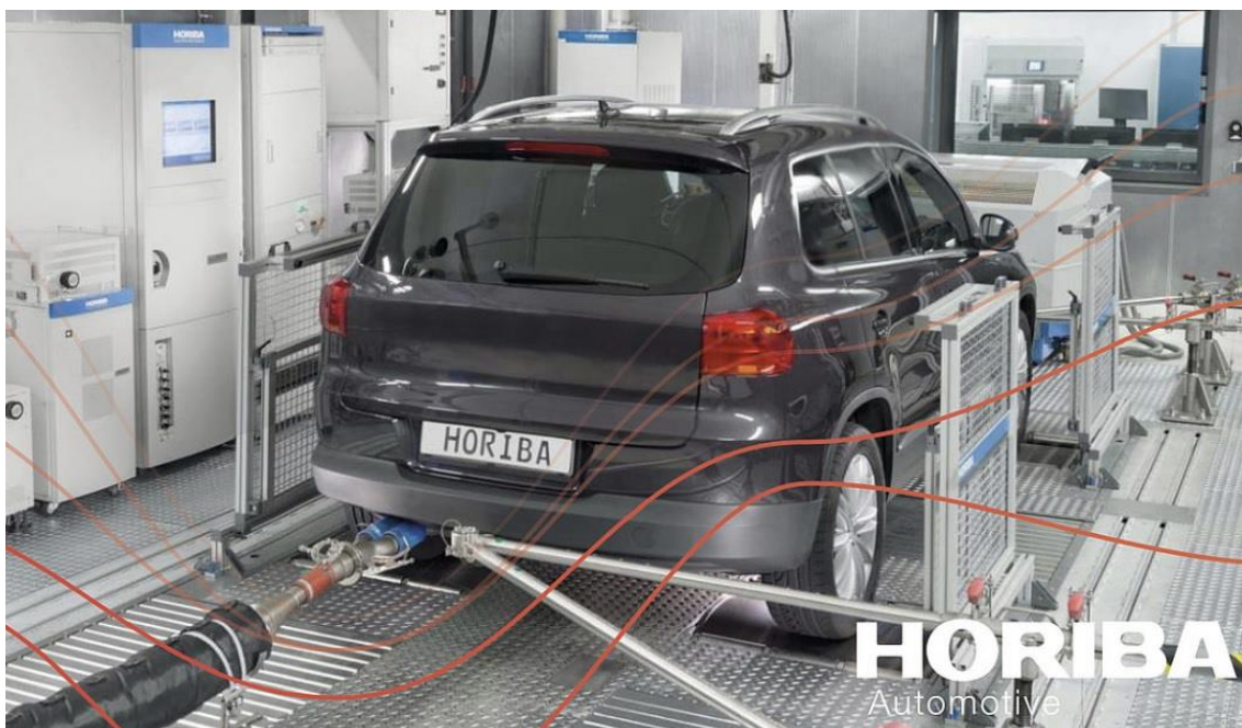
Σχήμα 3.5: Δυναμόμετρο πλαισίου και σύστημα μέτρησης καυσαερίων από την HORIBA Automotive [11]
