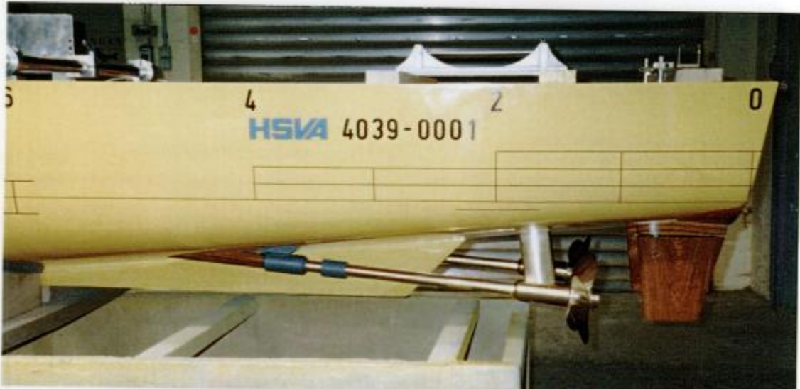
ΕΙΚΟΝΑ 9: ΠΡΟΤΥΠΟ ΥΠΟ ΚΛΙΜΑΚΑ ΠΛΟΙΟΥ ΜΕ ΠΑΡΕΛΚΟΜΕΝΑ
