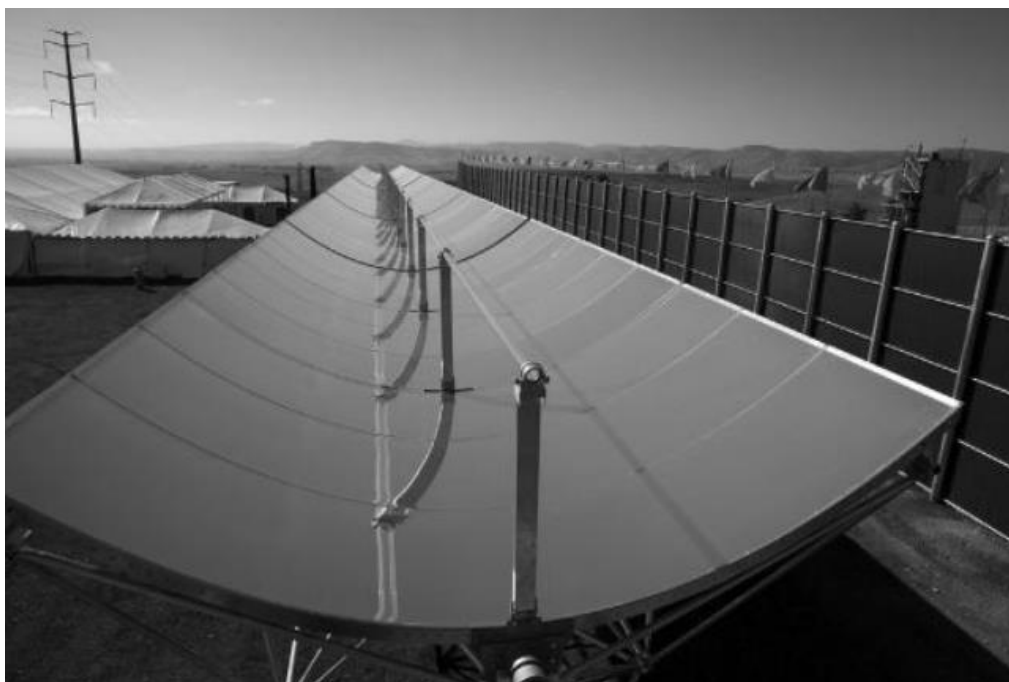
Εικόνα 2.4: Παραβολικός ηλιακός συλλέκτης (PTC) [10] .
