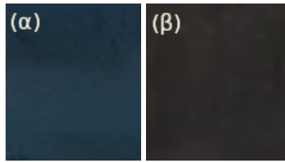
Σχήμα 2.1: Χημική σύνθεση \text{Cu}(\text{OH})_2 σε ηλεκτρόδιο \text{Cu} επιφάνειας 2 \times 2 \text{ cm} , (α) Ηλεκτρόδιο \text{Cu}(\text{OH})_2 και (β) ηλεκτρόδιο \text{CuO}
