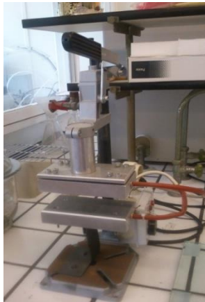
Σχήμα 4.3: (αριστερά) Πρέσα για τη σφράγιση των δυο ηλεκτροδίων και (δεξιά) μια εργαστηριακού τύπου σφραγισμένη DSSC.
