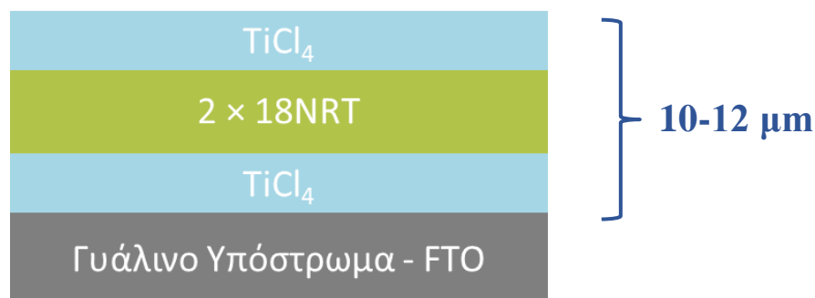
Σχήμα 7.2: Δομή ανόδου των προ-βιομηχανικών ηλιακών κυψελίδων.
