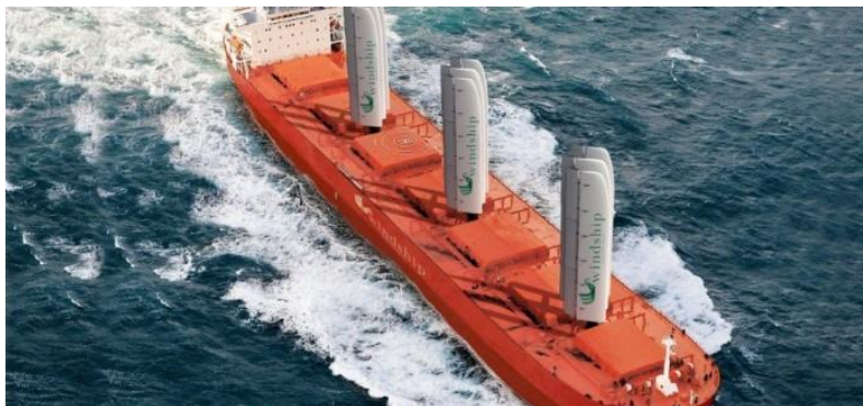
Σχήμα 2.3.3 Τεχνολογία τύπου Hard Sail εγκατεστημένη σε bulk carrier πλοίο. Πηγή: www.e-mc2.gr
