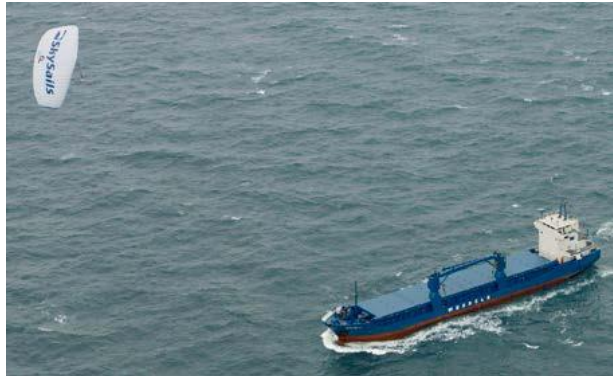
Σχήμα 2.3.5 Τεχνολογία τύπου Kite εγκατεστημένη σε general cargo πλοίο. Πηγή: DNV
