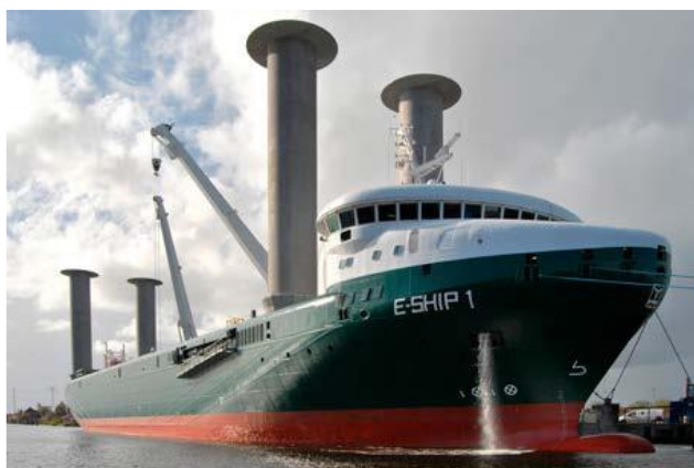
Σχήμα 2.3.4 Τεχνολογία τύπου Flettner rotor εγκατεστημένη σε general cargo πλοίο. Πηγή: DNV
