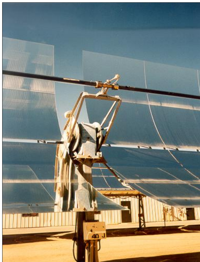
Σχήμα 2.2 Μηχανισμός οδήγησης κατόπτρου [7]
