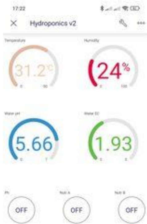
Εικόνα 41 Δεδομένα αισθητήρων σε πραγματικό χρόνο και εξ' αποστάσεως έλεγχος αντλιών στην εφαρμογή για κινητά
