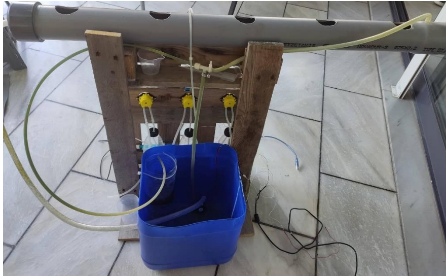
Εικόνα 25 Δομή υδροπονικού μοντέλου που αναπτύχθηκε
