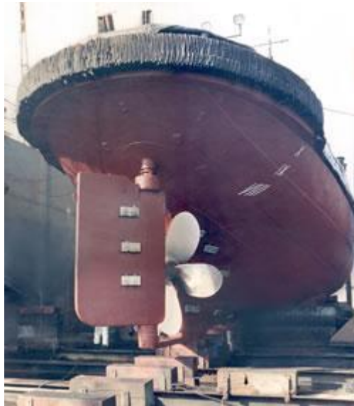
Καθοδική προστασία από θυσιαζόμενα ηλεκτρόδια σε πηδάλιο πλοίου
