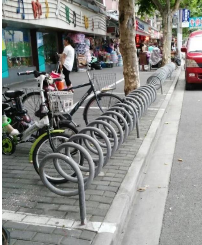
Εικόνα 5.23: Πρόταση στάθμευσης ποδηλάτων για εξοικονόμηση χώρου «σπείρα» (ChinaBikerack, 2015)
