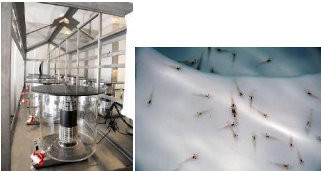
Εικόνα 2.4: Δεξαμενή διεξαγωγής δοκιμής τοξικότητας στις εγκαταστάσεις του CEDRE. [11]
