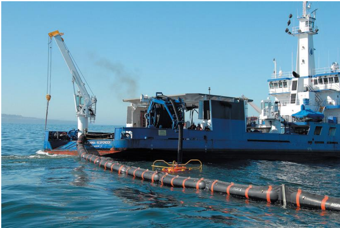
Εικόνα 1.9: Εγκλωβισμός και ανάκτηση του πετρελαίου.
