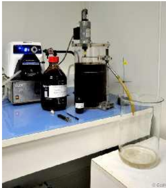
Εικόνα 2.3: Διάταξη δοκιμής μεθόδου αποτελεσματικότητας χημικών διασκορπιστικών ουσιών IFP. (CEDRE). [11]
