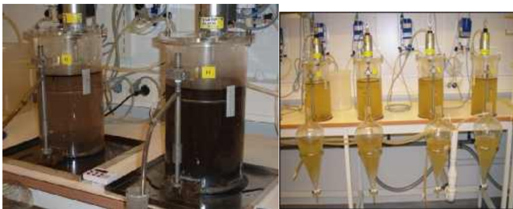
Εικόνα 2.5: Διάταξη δοκιμής αποτελεσματικότητας διασκορπιστικού με τη μέθοδο IFP στα εργαστήρια του ινστιτούτου SINTEF της Νορβηγίας (SINTEF). [11]
