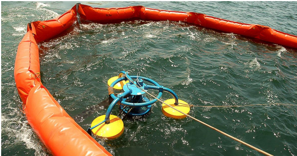
Εικόνα 1.12: Ελαιοσυλλέκτης με χείλος υπερχειλίσσης και πλωτήρες (weir skimmers). Πηγή: https://spillpro.com.au/information-and-news/the-applications-and-benefits-of-weir-skimmers
