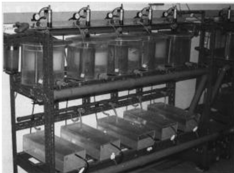
Εικόνα 2.10: Δεξαμενές μηχανικής ανάδευσης (επάνω) και ανάρρωσης (κάτω) μιας δοκιμής τοξικότητας Sea Test του Ηνωμένου Βασιλείου. Κάθε δοκιμή αποτελείται από πέντε επαναλήψεις (replicates). [30]
