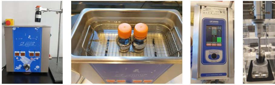
Σχήμα 38: (αριστερά) Προετοιμασία μελανών με την κατεργασία Λουτρού Υπερήχων (Ultra-sonication Bath) και (δεξιά) Υπερηχητικού τύπου-Καθετήρα (Ultra-sonication Probe)
